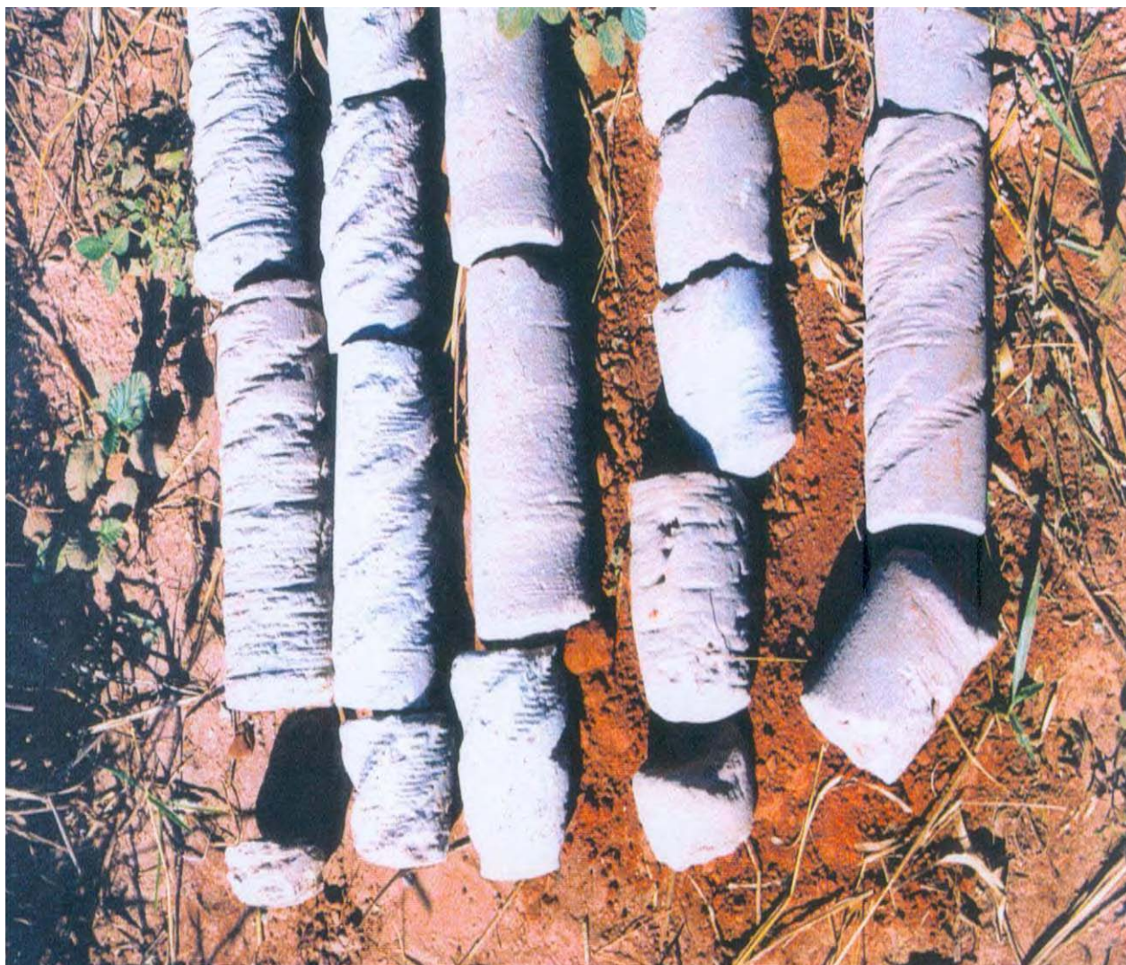
Figura36 - Amostras do embasamento rochoso, arenitos finos de cor cinza, da Formação Adamantina, extraídas de poço de monitoramento. Fonte: Arquivo Pessoal
