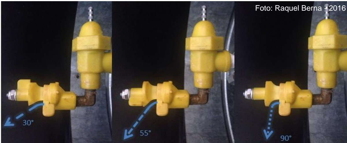
Figura 1 Ponta de pulverização de jato plano de impacto, modelo CP-03, com três posicionamentos dos ângulos defletores
