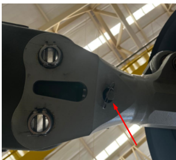
(b) Reservatório para armazenamento das esferas localizado no punho do rotor.
