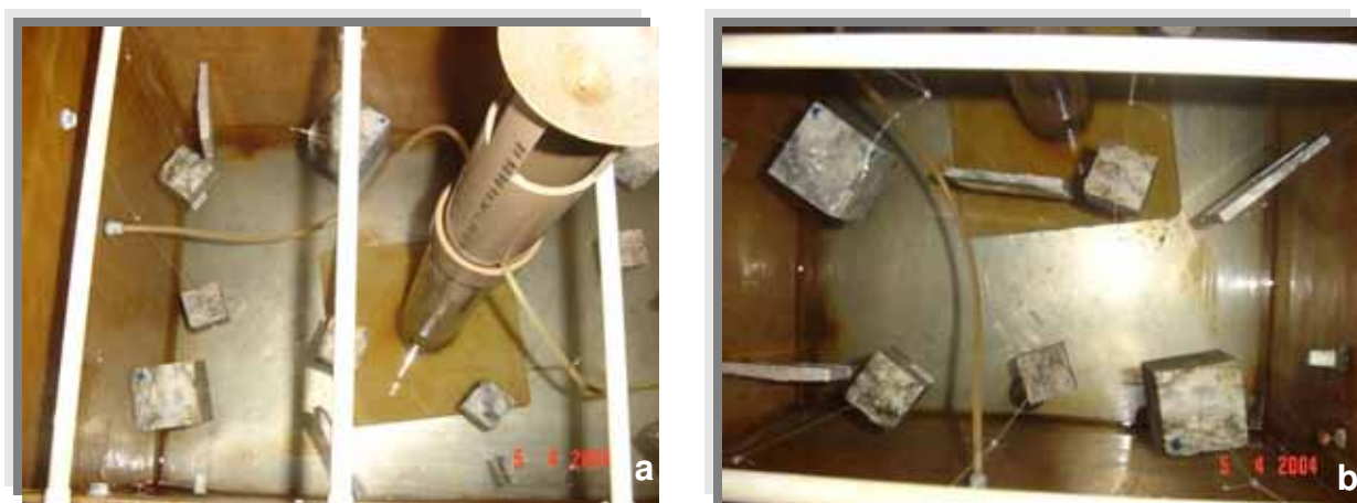
Figura 2.1. a e b – Vista do interior da câmara climática de ensaio contínuo em névoa salina (Modelo Bass USC) exibindo corpos-de-prova suspensos por fios de nylon.
