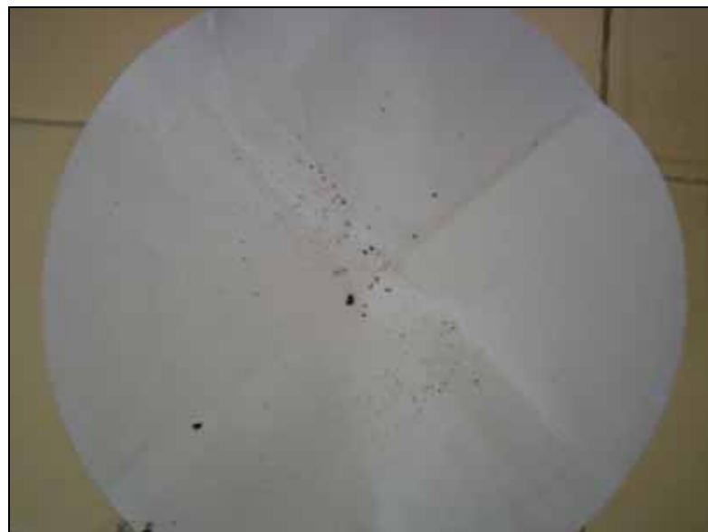
Figura 6.30 – Resíduo de filtragem da 4ª lavagem contendo pequenas placas (ou lascas) de biotita, muscovita e hidróxidos de ferro, além de grãos de feldspato e quartzo.
