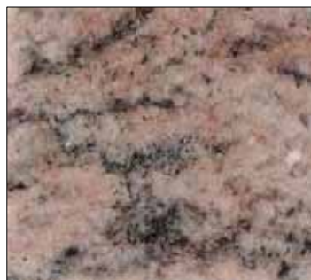
Figura 6.22 – Amostras dos gnaisses Casablanca, Delicato e Falésia onde foram realizadas as medidas de dureza e brilho para determinação do índice de alterabilidade (Placas 5cm x 5cm x 5cm).
