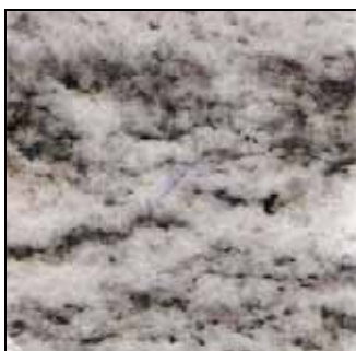
Figura 6.22 – Amostras dos gnaisses Casablanca, Delicato e Falésia onde foram realizadas as medidas de dureza e brilho para determinação do índice de alterabilidade (Placas 5cm x 5cm x 5cm).
