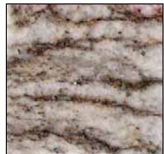
Figura 6.22 – Amostras dos gnaisses Casablanca, Delicato e Falésia onde foram realizadas as medidas de dureza e brilho para determinação do índice de alterabilidade (Placas 5cm x 5cm x 5cm).
