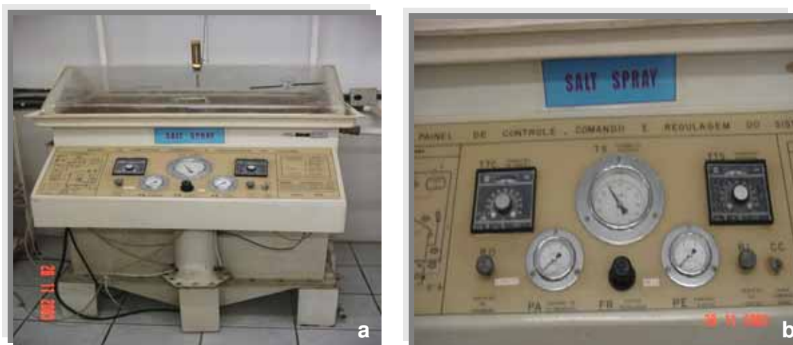
Figura 2.2. – Vista da câmara climática de ensaio contínuo em névoa salina (a) e detalhe do painel onde se tem o controle de temperatura, vazão de líquido e pressão de ar do bico pulverizador (b).
