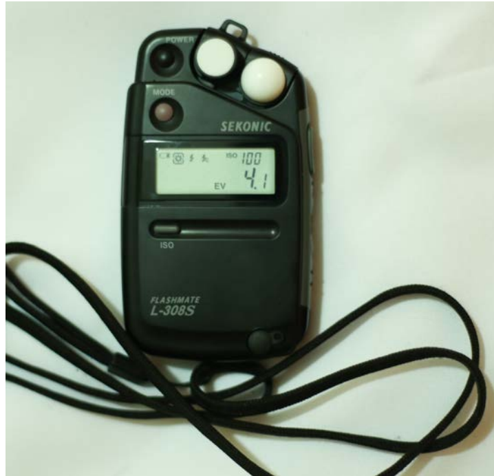
Figura 7: Lumidisc acoplado ao fotômetro Fonte: Autor
