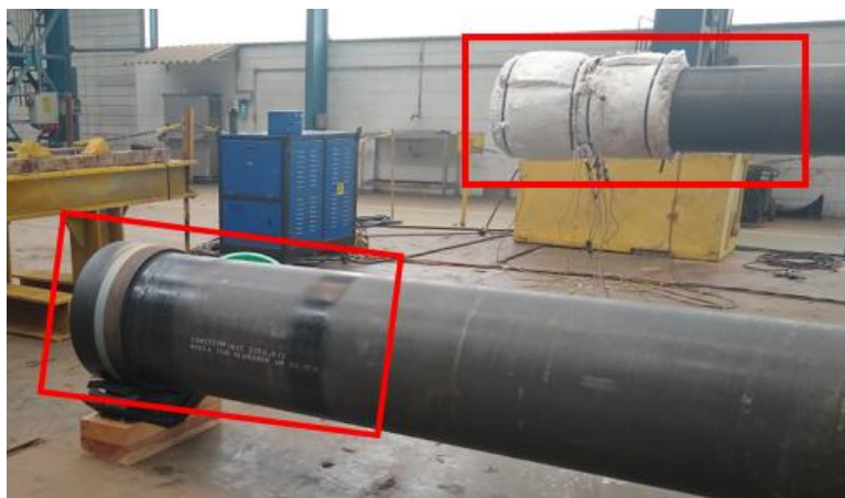
Figura 63. Local de retirada dos corpos de prova.
