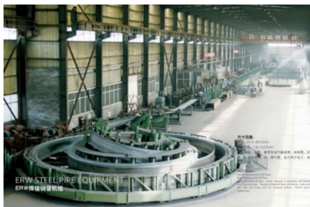
Figura 17. Linha ERW completa com stand de rolos ajustáveis e pulmão de chapas.
