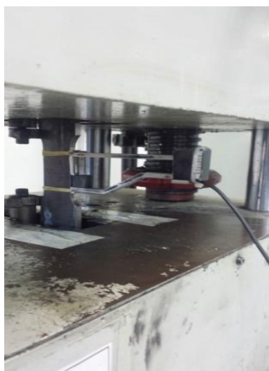
Figura 75. Fixação do extensômetro de corpo duplo no corpo de provas.
