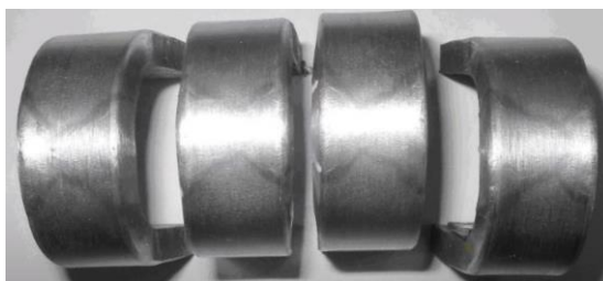
Figura 123. Corpos de prova similares aos obtidos nos ensaios de dobramento guiado-Plano lateral.
