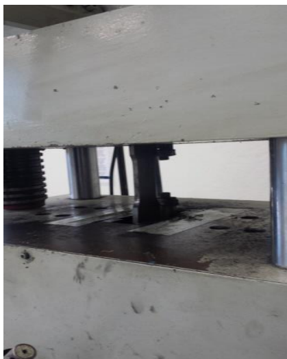
Figura 74. Corpo de prova posicionado para o ensaio de tração.
