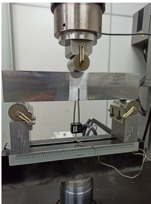
Figura 85. C.P. posicionado na Máquina de ensaio MTS 250 kN MTS 810 e sensor de medição posicionado para medição de abertura da pré-trinca.
