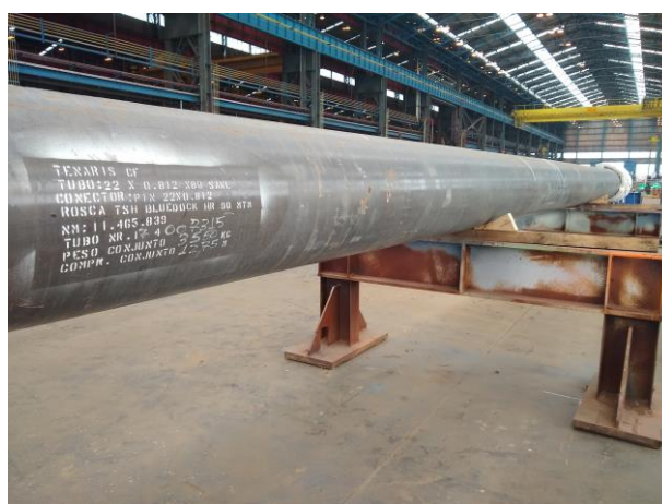
Tubo posicionado e apoiado para execução do Tratamento Térmico.
