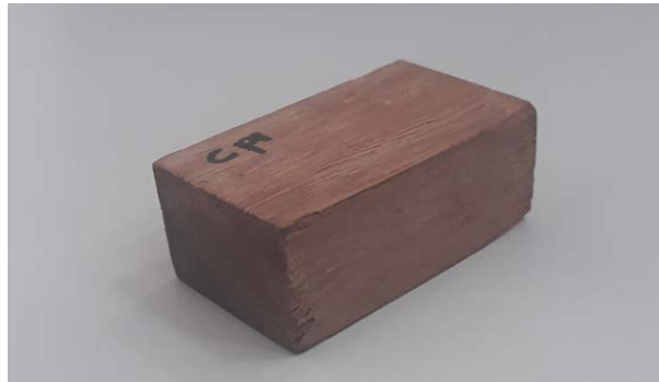
Figura 7 – Amostra extraída para determinação do teor de umidade
