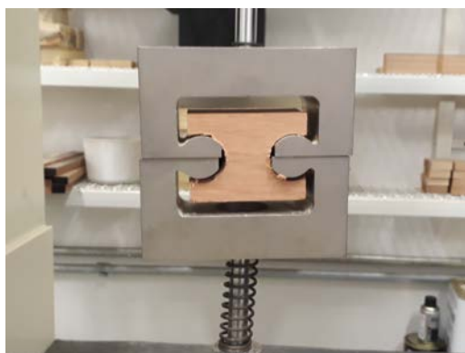
Figura 8 – Ensaio de tração normal às fibras
