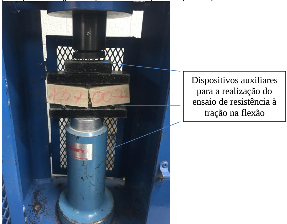
Figura 7 – Corpo de prova de argamassa posicionado na prensa, após a ruptura
