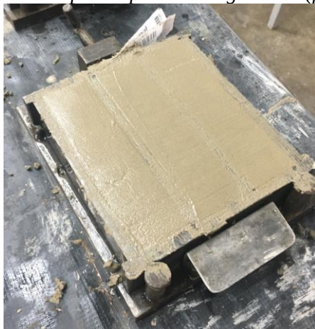
Figura 5 – Moldagem dos corpos de prova de argamassa (fôrma de 40x40x160cm).
