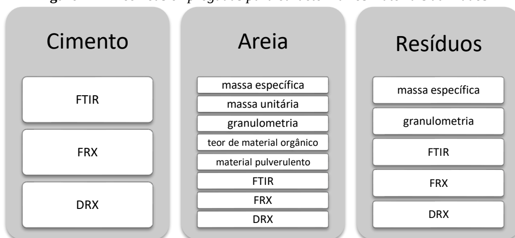
Figura 4 – Técnicas empregadas para caracterizar os materiais utilizados
