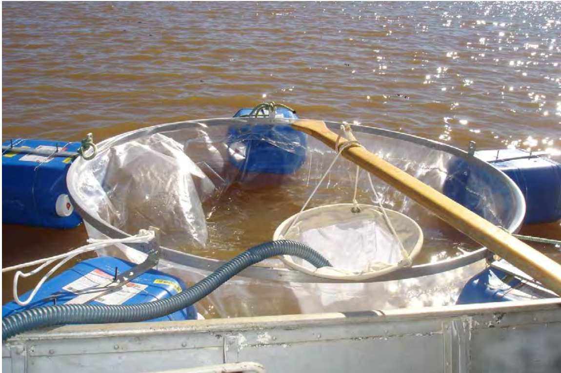
Figura 5 – Enchimento de enclosure . Detalhe: cano da bomba despejando a água dentro da rede de zooplâncton com abertura de malha de 50 \mu m.
