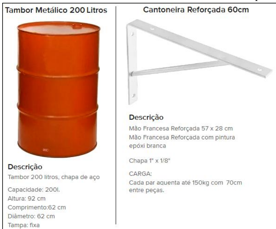
Figura 26: Tambor metálico utilizado como reservatório e cantoneira para fixação.
