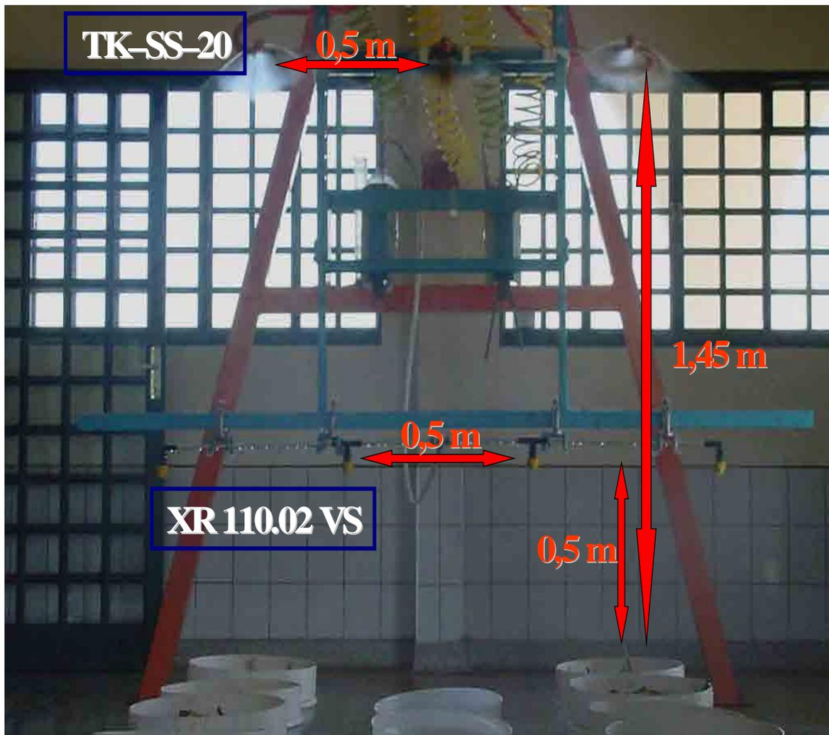
**Figura 1.** Sistemas de simulação de chuva (precipitação) e de pulverização do NuPAM.
