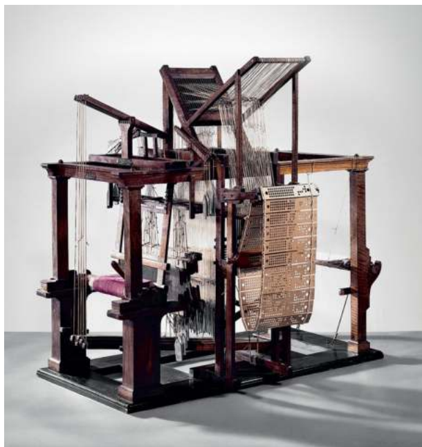
Figura 14 - Tear com o sistema de Jacquard
