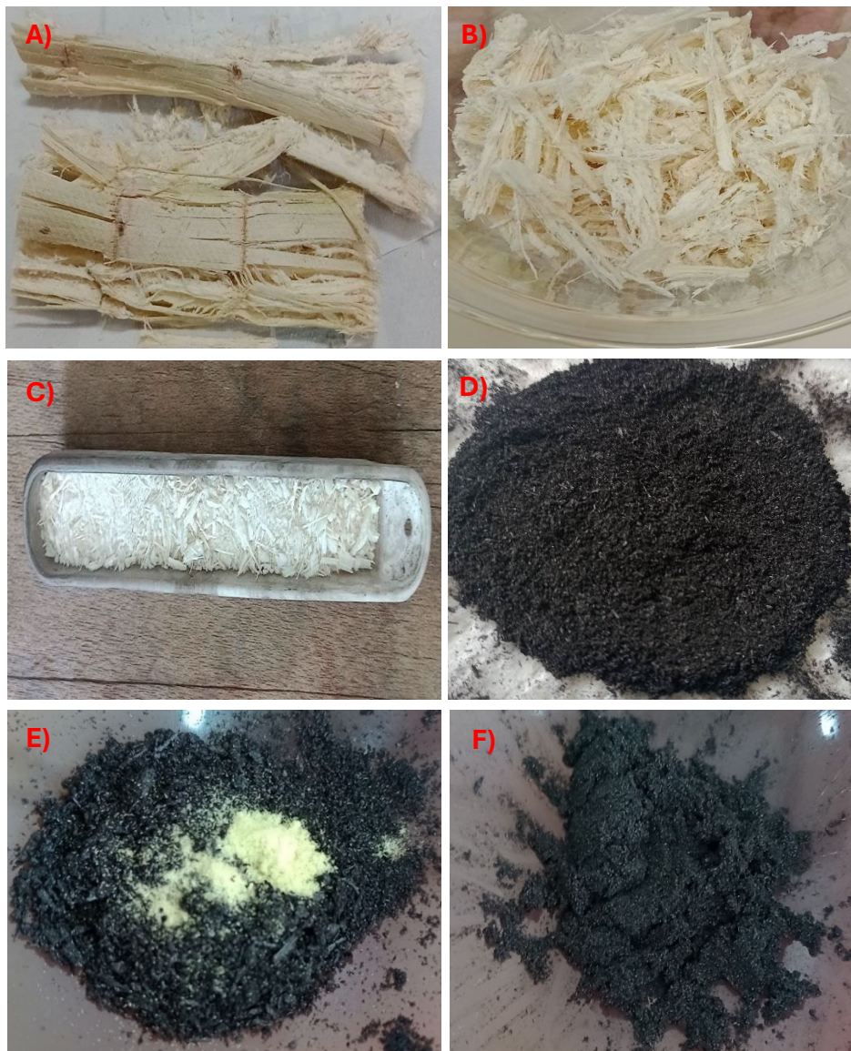
Figura 5 - Etapas de transformação do bagaço de cana-de-açúcar: (A) resíduo de bagaço após moagem; (B) medula separada da casca antes da lavagem; (C) medula após secagem e trituração; (D) medula após calcinação a 400 °C em atmosfera de nitrogênio. (E) bagaço calcinado de 400 °C com acetilacetionato de Pt (II) na figura 5(F) mostra o material macerado.
