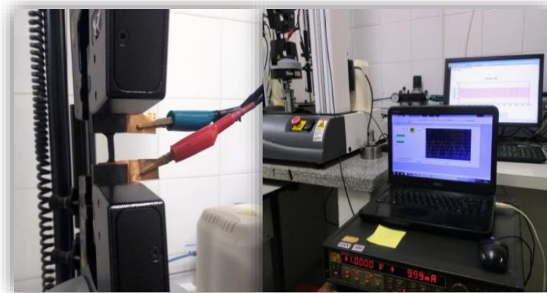
Figura 29 -Sistema utilizado para a realização das medidas de piezoresistividade.
