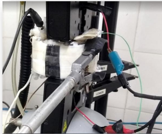
Figura 31 - Forninho desenvolvido para as medidas de piezoresistividade com diferentes temperaturas.
