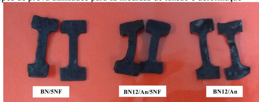
Figura 28 - Corpos de prova utilizados para as medidas de tensão e deformação
