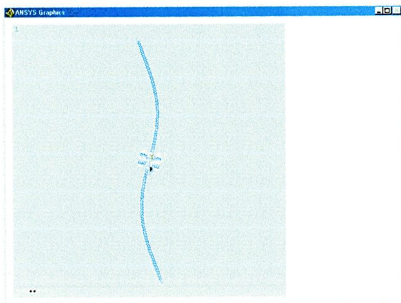
FIGURA 4.17- Segundo modo de vibração ( f_2 = 121,43 Hz)
