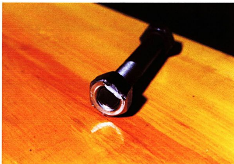
FIGURA 5.19 - Conjunto parafuso e porca após ensaio de tração
