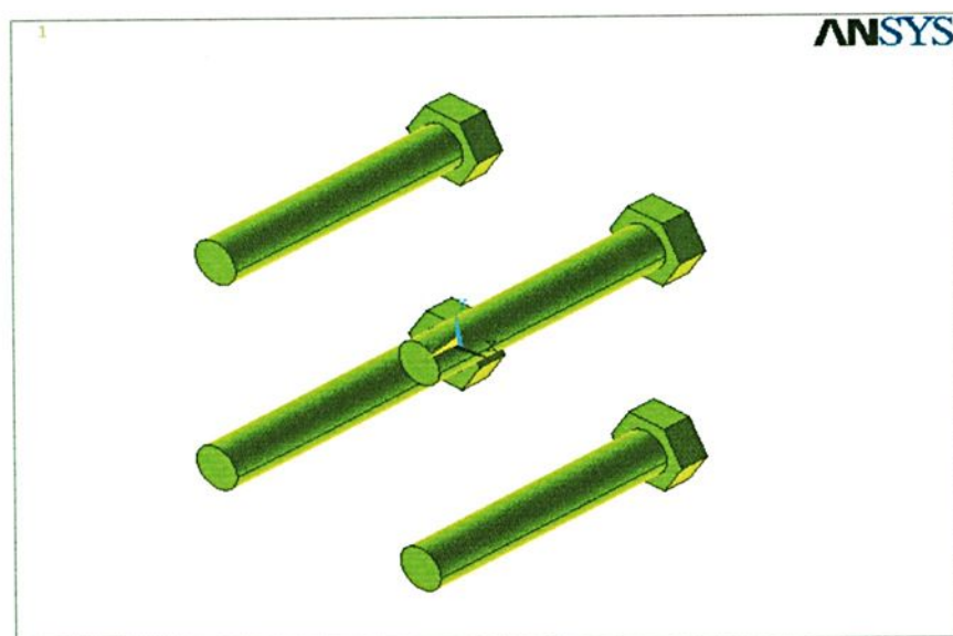
FIGURA 4.3 - Modelos dos parafusos sextavados – M14
