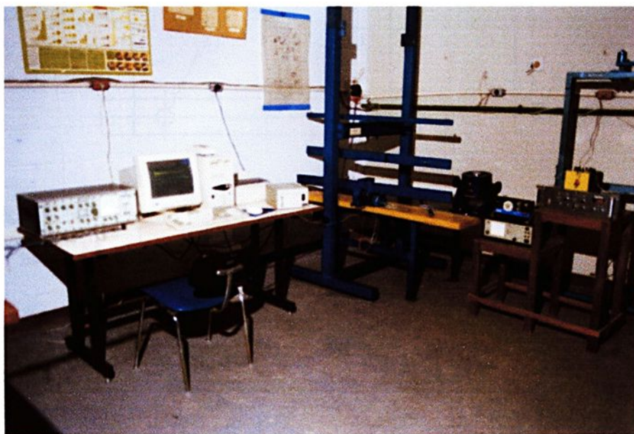
FIGURA 5.23 - Bancada experimental utilizada nos ensaios de vibrações das vigas
