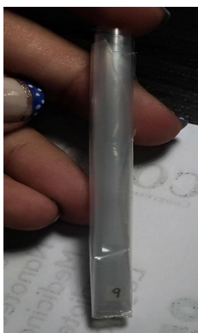
Figura 8: Dosímetro protegido utilizado para o mapeamento do setor de radioterapia.
