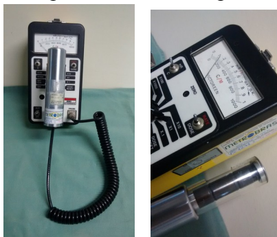
Figura 2: Geiger Müller utilizado na realização do levantamento radiométrico do setor de radioterapia do HC da Unesp de Botucatu.
