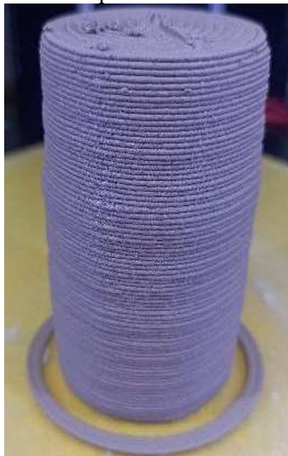
Figura 67 – Amostra cilíndrica impressa em 3D com a formulação GP1-4,75 M
