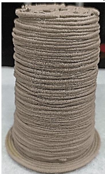
Figura 72 – Amostra cilíndrica impressa em 3D com a formulação GP11 de geopolímero na molaridade de 7,46 M e com 0,05% de reforço de fibras de polipropileno
