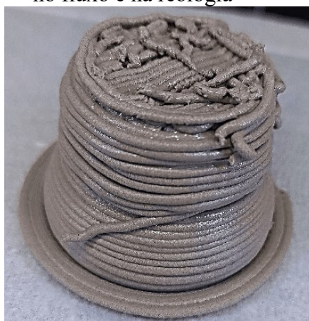
Figura 70 – Amostra de geopolímero impressa com a formulação GP10 exibindo falhas no fluxo e na reologia
