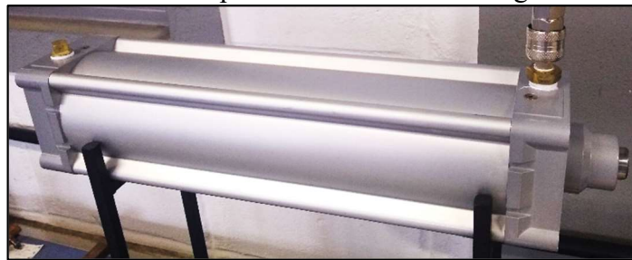
Figura 36 – Foto do reservatório pneumático ISO 6431 original em liga de alumínio
