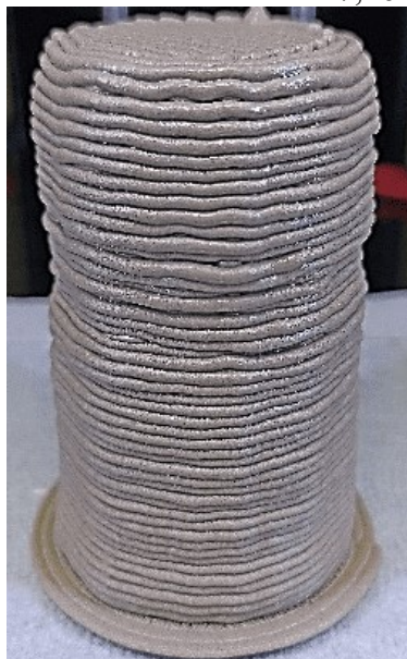
Figura 71 – Amostra cilíndrica impresso em 3D com a formulação GP11 de geopolímero na molaridade de 7,46 M
