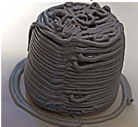
Figura 69 – Amostra de geopolímero impressa com a formulação GP9 exibindo falhas no fluxo e na reologia
