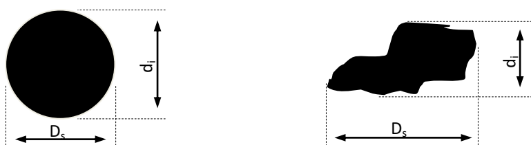
Figura 4.2 Projeção horizontal e vertical de partículas para determinação do maior ( D_s ) e menor ( d_i ) diâmetro projetado.
