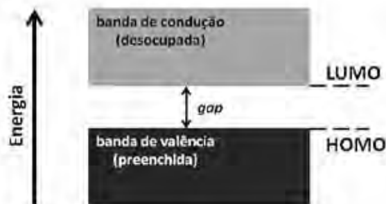
Figura 2.4 – Diagrama de energia de um material semicondutor. Assim como os semicondutores inorgânicos, os polímeros conjugados apresentam uma lacuna, gap , que separa a banda de valência (originada de orbitais \pi ) da banda de condução (originadas de orbitais \pi^* ).
