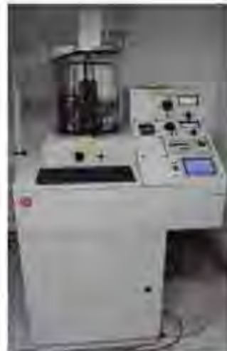
Figura 3.8 – HHV Auto 306. Evaporadora utilizada na deposição de eletrodos metálicos termicamente evaporados.
