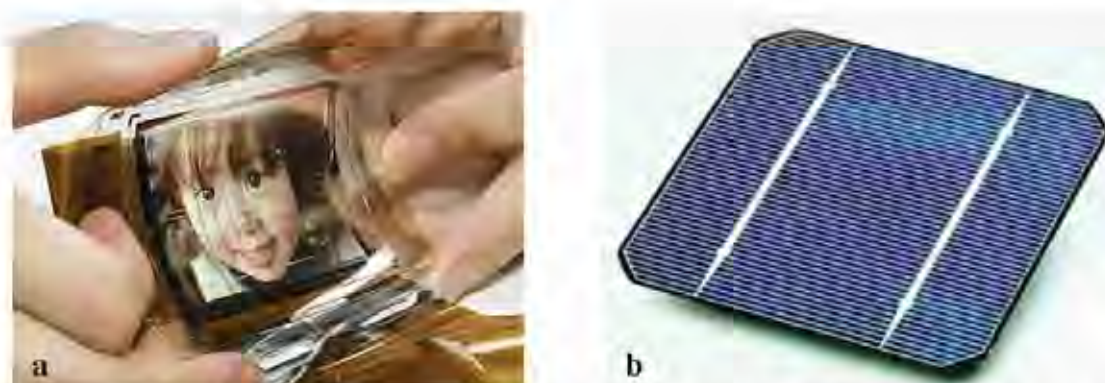
Figura 2.1 – Aplicação de polímeros condutores em eletrônica orgânica. (a) Display flexível de OLEDs utilizados em celulares e porta-retratos, fabricante Sony ® (b) Célula solar polimérica ( http://www.bluesci.org/ ).
