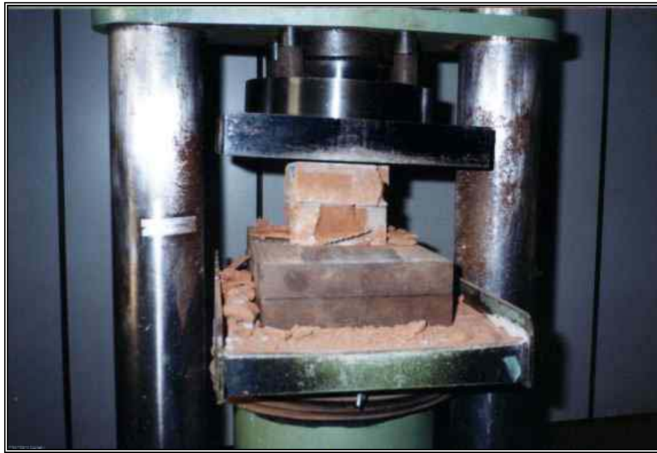
Figura 4.9 – Ensaio de compressão : Tijolo Solo-Cimento
