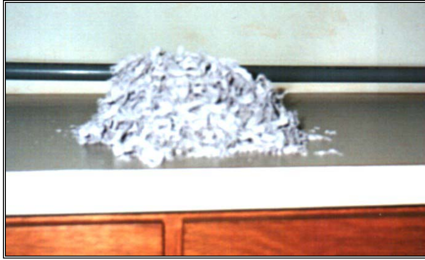
Figura 3.1 – Vista geral da serragem cromada em tiras
