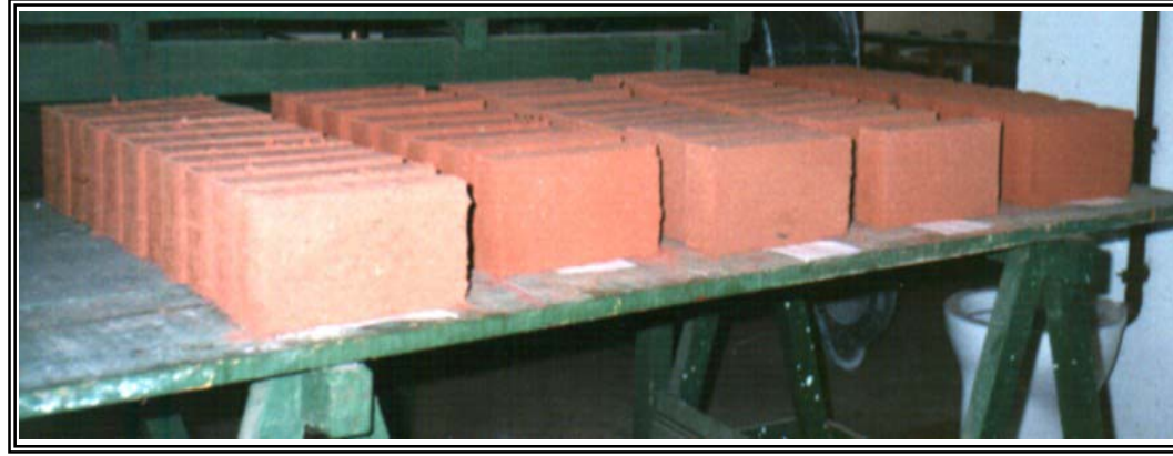
Figura 4.5 – Tijolo Solo-Cimento (1º Traço)
