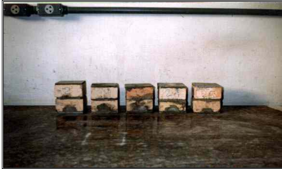
Figura 4.8– Tijolos de argila ao forno, preparados para o ensaio
