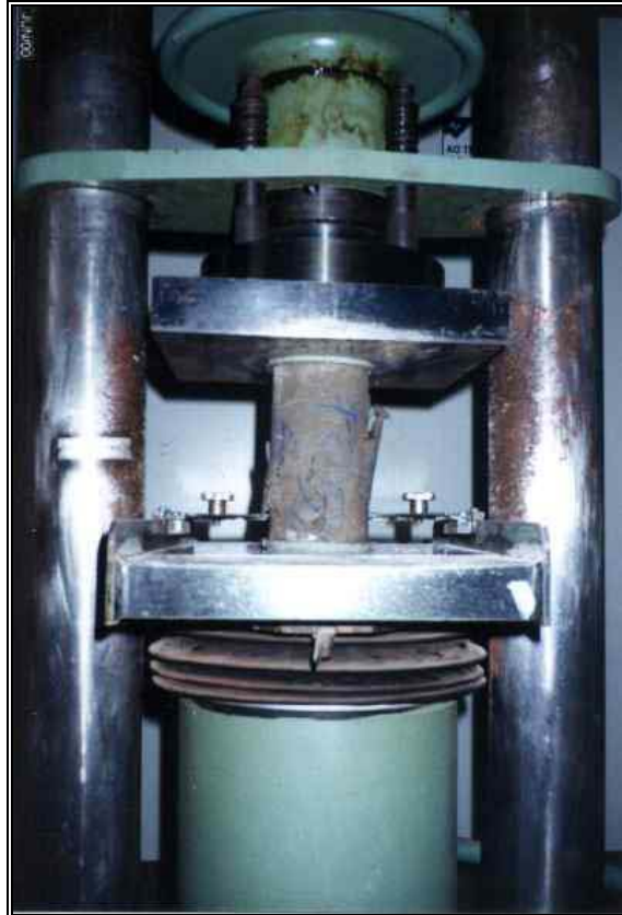
Figura 4.10 – Ensaio de compressão: CP de concreto
