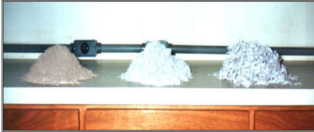
Figura 3.2 – Da esquerda para a direita : pó de lixadeira – serragem moída - tiras
