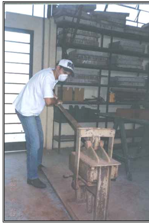
Figura 4.7 –Operação de prensagem manual
