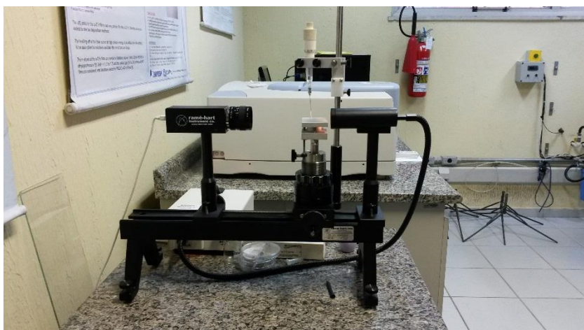
Figura 15: Goniômetro Ramé-Hart 100-00 utilizado para análises de molhabilidade e energia de superfície.
