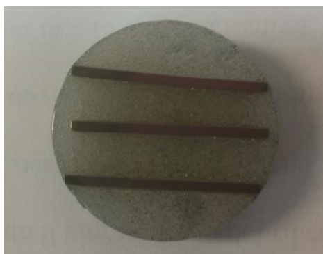
Figura 17: Amostra de três deposições diferentes embutidas e lixadas, prontas para a análise por MEV/EDS.
