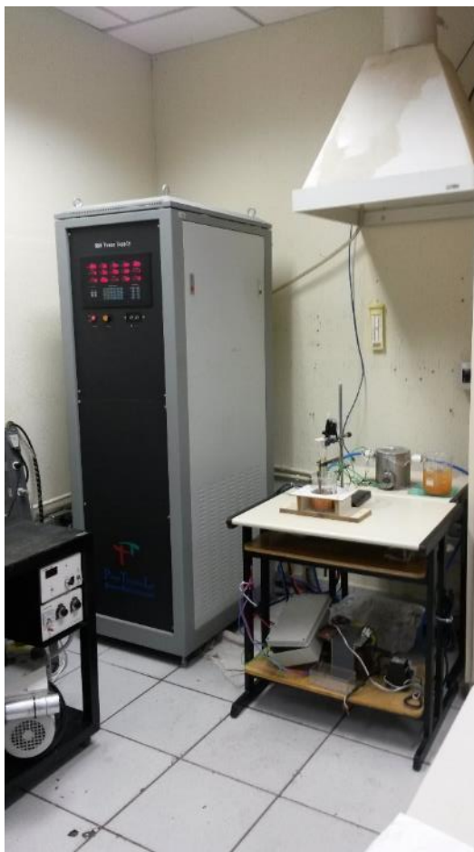
Figura 10: Sistema do plasma eletrolítico. À esquerda da foto, a fonte de tensão e à direita, na mesa da frente, o sistema de eletrólise.
