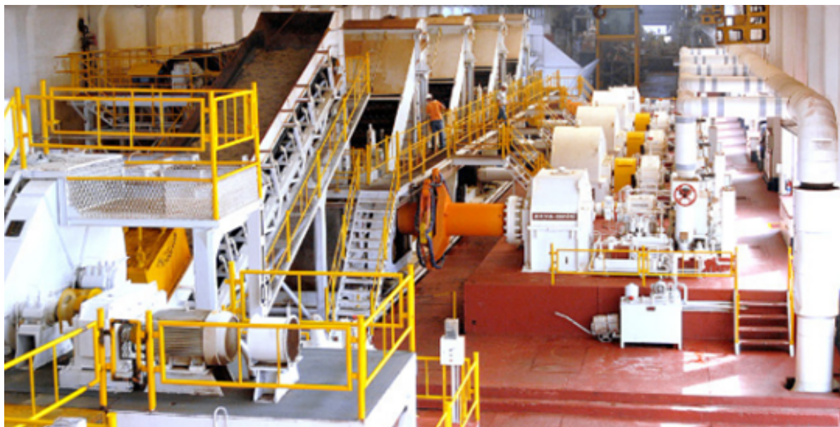
Figura 33 – Terno de Moenda com acionamento a vapor.
