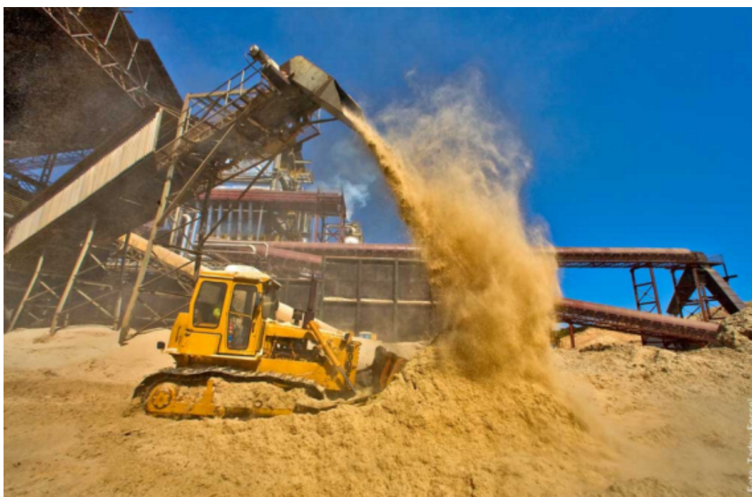
Figura 23 – Bagaço oriundo da moagem da cana para envio as caldeiras.
