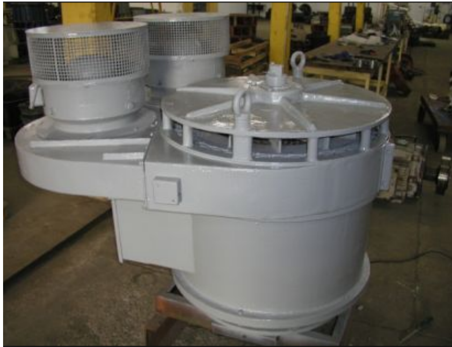
Figura 36 – Motor multi-pólos de 150kW/380V - 4/6/12/24 Pólos, com dois ventiladores adicionais.
