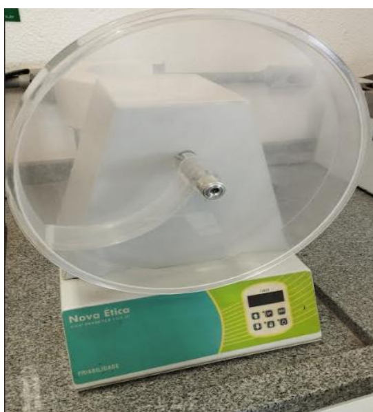
Figura 3: Friabilômetro Nova Ética modelo 300-1 utilizado no teste de Friabilidade.
