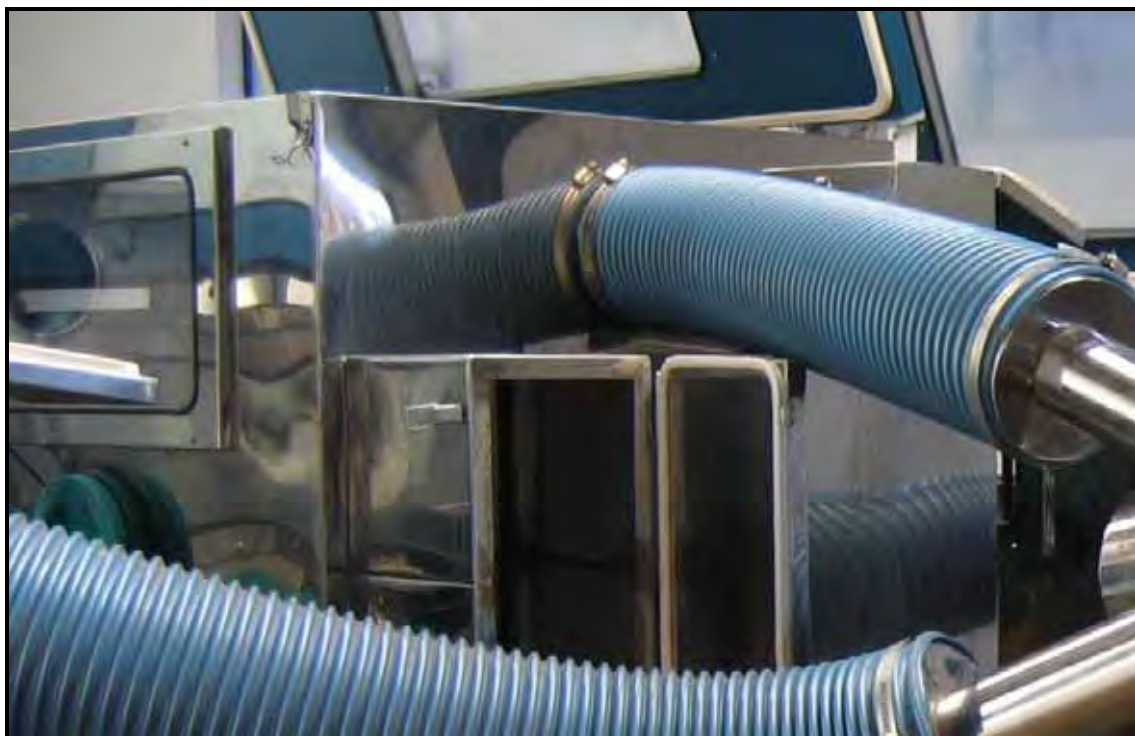
Figura 4. Câmara de passagem – vista externa
