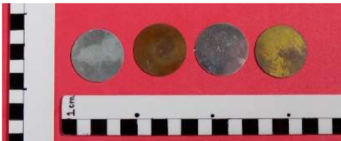
Fotografia 20 - Discos com diferentes metais (grafado em relevo) para observação do efeito fotoelétrico.
