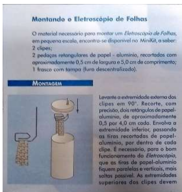
Imagem 2 – Instrução de montagem do eletroscópio.
