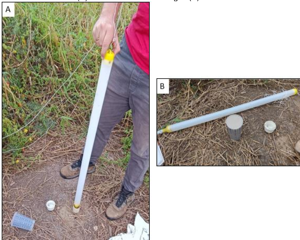
Figura 33 – Uso do Bailer (A) e retirada de volume d'água (B).
