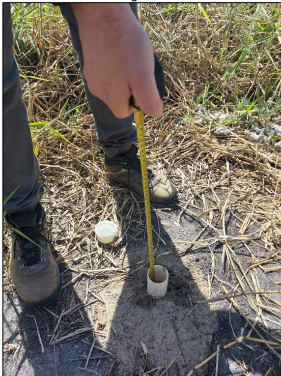
Figura 34 – Aquisição de dados da coluna d'água.
