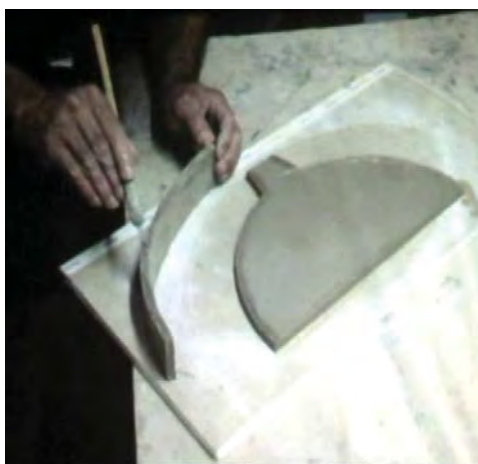
Figura 72: Ateliê Anand . Passo 5 - Com uma ponta seca, fazer ranhuras em diversos sentidos, nas partes que receberão barbotina 45 .
