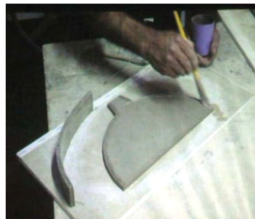
Figura 73: Ateliê Anand . Passo 6 - Com um pincel, passar a barbotina sobre as ranhuras, isso garantirá a aderência desejada às partes a serem coladas.
