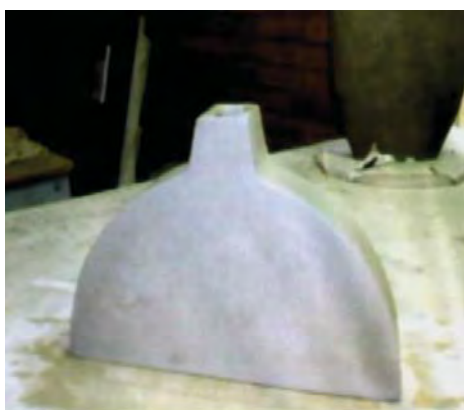
Figura 76: Ateliê Anand . Passo 9- Repete-se o procedimento até que todas as partes estejam unidas, e a peça modelada.
