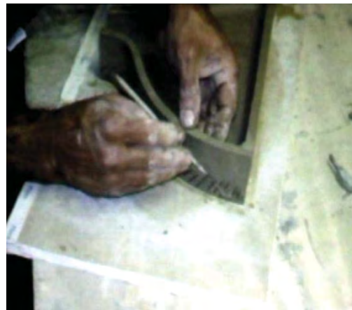
Figura 75: Ateliê Anand . Passo 8- Do lado externo da peça, faz-se uma “costura” (ranhuras profundas em vários sentidos, para que as duas partes interajam ainda melhor). Com uma ferramenta tipo espátula, faz-se o acabamento (alisamento).
