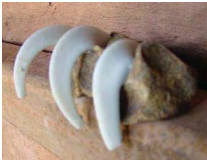
Figura 59: Cones pirométricos utilizados no forno Noborigama do Ateliê Oficina da Cerâmica. Da direita para a esquerda, cone nº 8,9,10.
