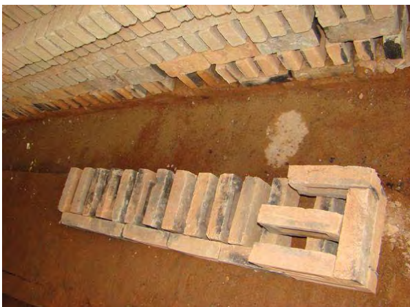
Figura 42: Esquema de montagem dos tijolos em uma caieira.
