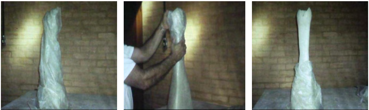
Figura 87: Exemplo de aplicação de plástico no auxílio à secagem de peça.
