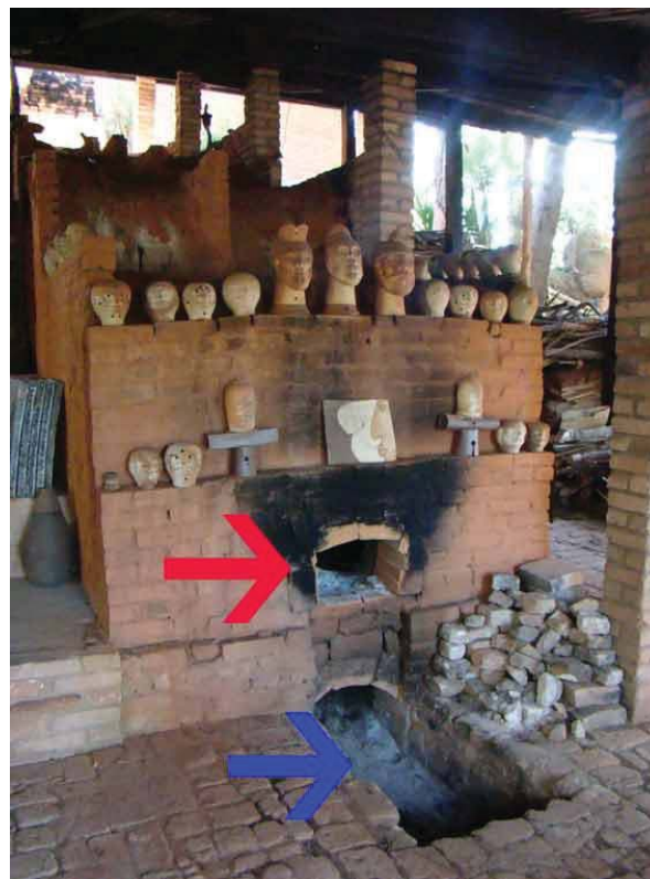
Figura 57: Forno do Ateliê Mieko & Mário, com três aberturas de alimentação (tapadas por chapas de metal). A queima inicia-se na abertura apontada pela seta azul.
