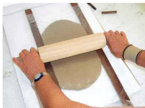
Figura 77: Produção de placas com auxílio de sarrafos e rolo de macarrão. Passo 1- Coloca-se a argila entre dois sarrafos presos a uma mesa e com auxílio de um rolo abre-se a placa.
