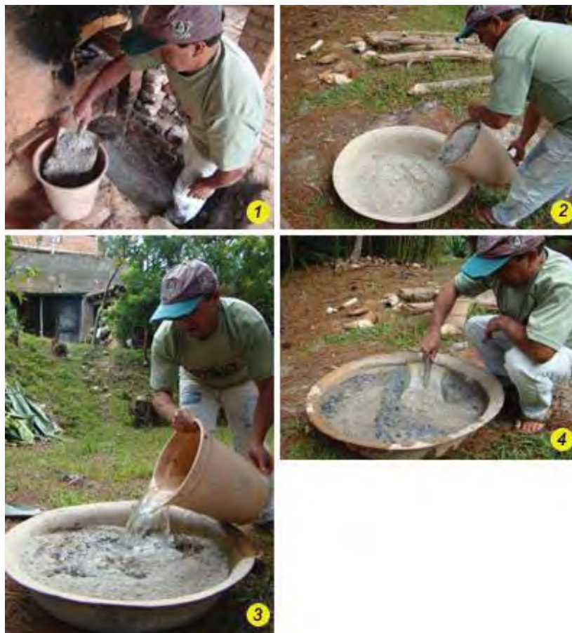
Figura 88: 1- Elias retirando cinzas da fornalha, 2- colocando-as em uma bacia, 3- adicionando água, 4- mexendo a mistura com um pá, para depois deixar decantar e eliminar os resíduos indesejados e a água, 2009.
