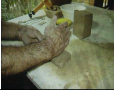
Figura 80: Ateliê Anand .Passo 2- Para corrigir as maiores irregularidades achata-se a placa, com as mãos.
