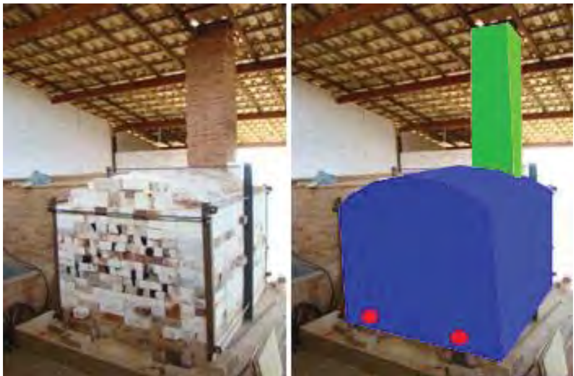
Figura 99: Forno a gás (3,70m alt X 2,00 m larg X 2,10 m prof). ● Entrada dos maçaricos, ● Câmara, ● Chaminé.
