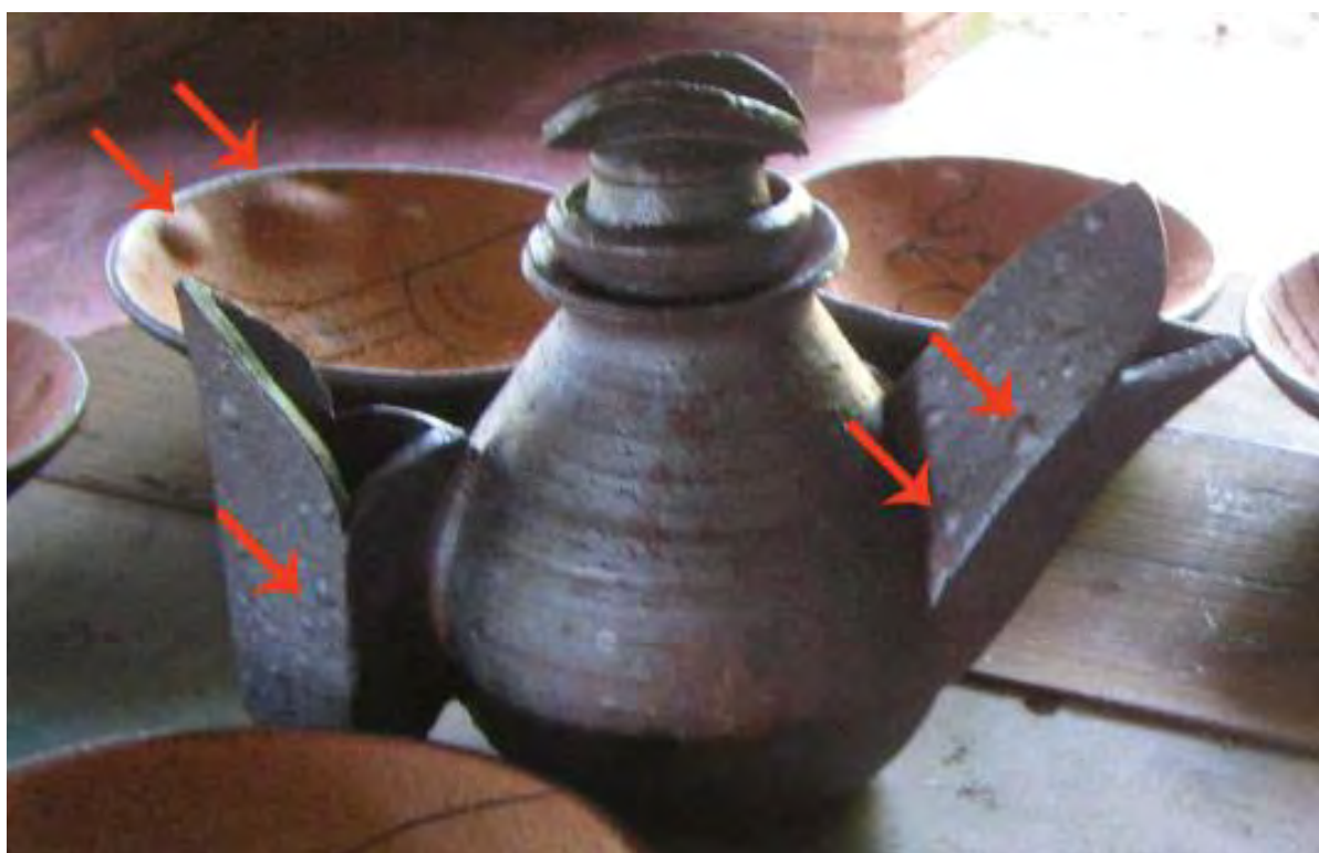
Figura 66: Bolhas formadas pela ação do calor, Ateliê Antigo Matadouro, 2006.
