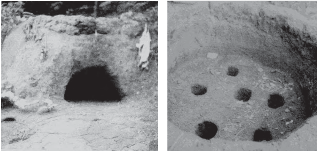
Figuras 16 e 17: Típico Forno de Barranco usado por paneleiras de Cunha. À direita: detalhe da parte superior, destinada à acomodação das peças a serem queimadas.
