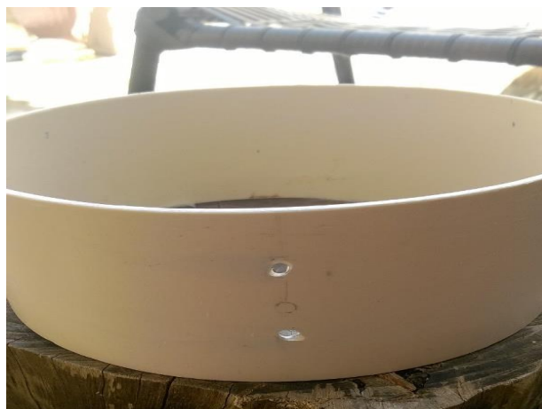
Figura 3 Cano PVC 200mm Cortado e Furado.
