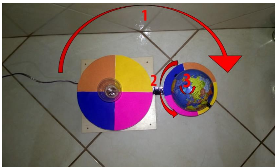
Figura 15 Eixos de rotação que é possível efetuar no simulador.
