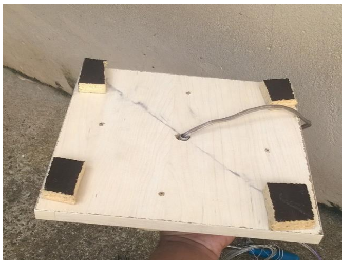
Figura 5 Base, com o furo e já passado o bastão juntamente com o fio paralelo.
