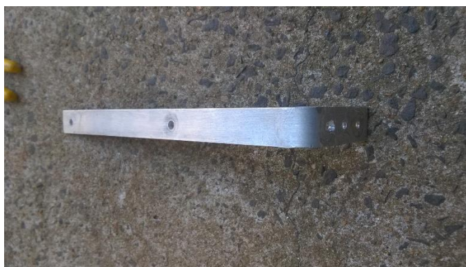
Figura 4 Barra de alumínio dobrada juntamente com os furos indicados.
