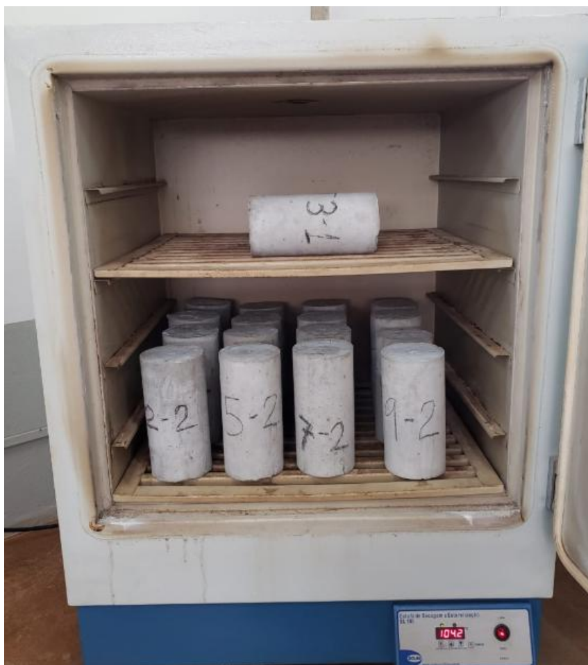
Figura 13 – Corpos de prova na estufa a 105°C
