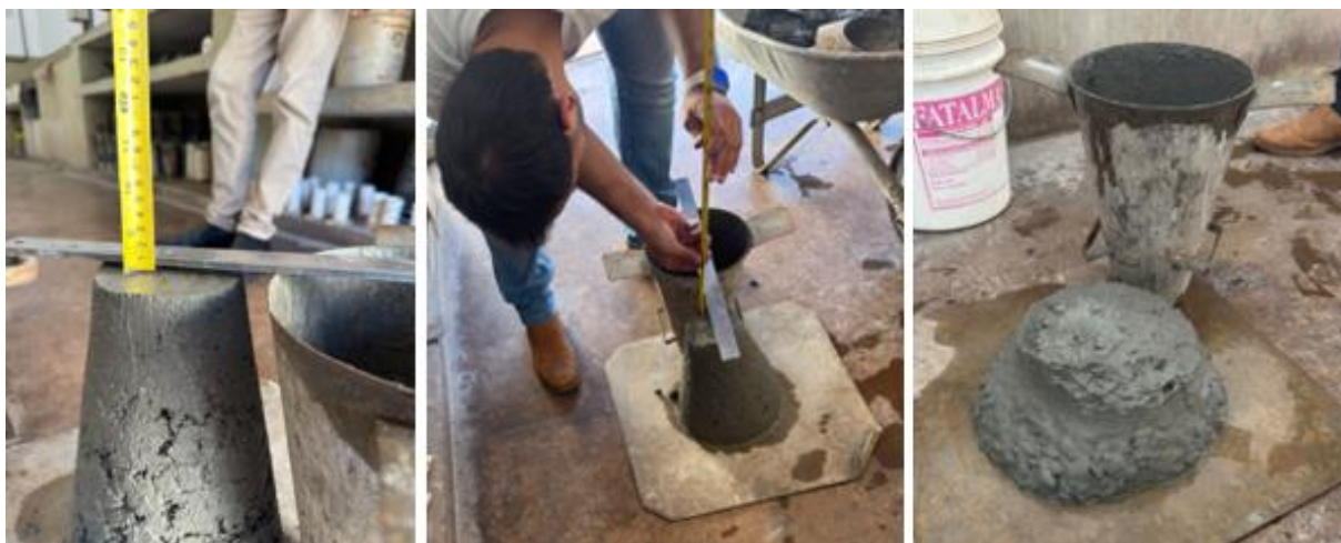
Figura 16 – Abatimento dos três primeiros traços
