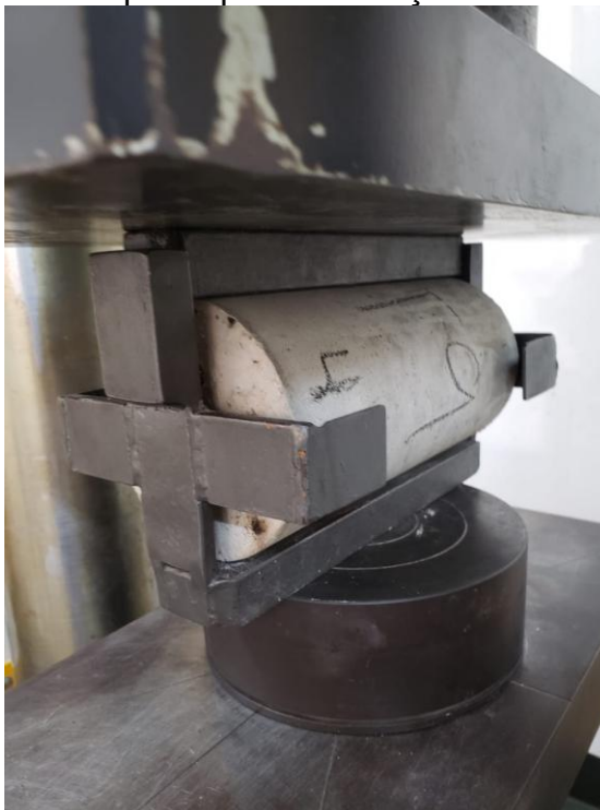
Figura 12 – Corpo de prova do traço 3 antes de romper
