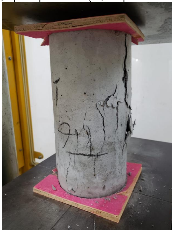
Figura 20 – Corpo de prova do traço 6 rompido axialmente a 28 dias
