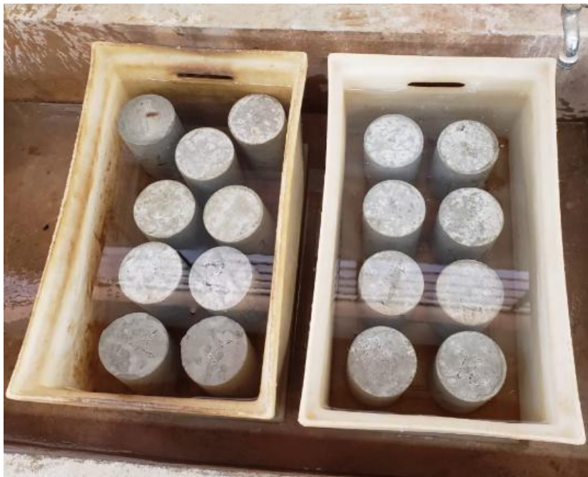
Figura 14 – Corpos de prova imersos a 25°C
