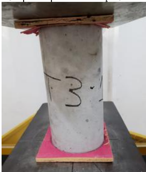
Figura 10 – Corpo de prova do traço 3 antes de romper
