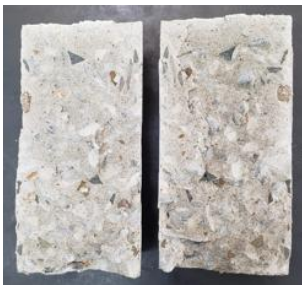
Figura 22 – Corpo de prova do traço 9 rompido a 28 dias
