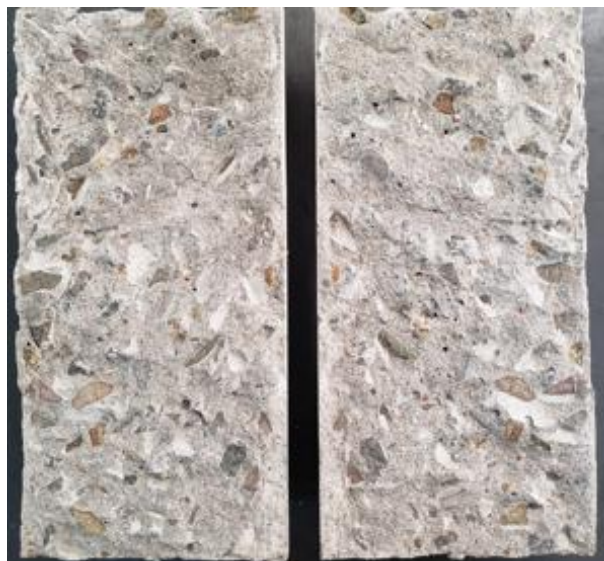
Figura 21 – Corpo de prova do traço 1 rompido a 28 dias
