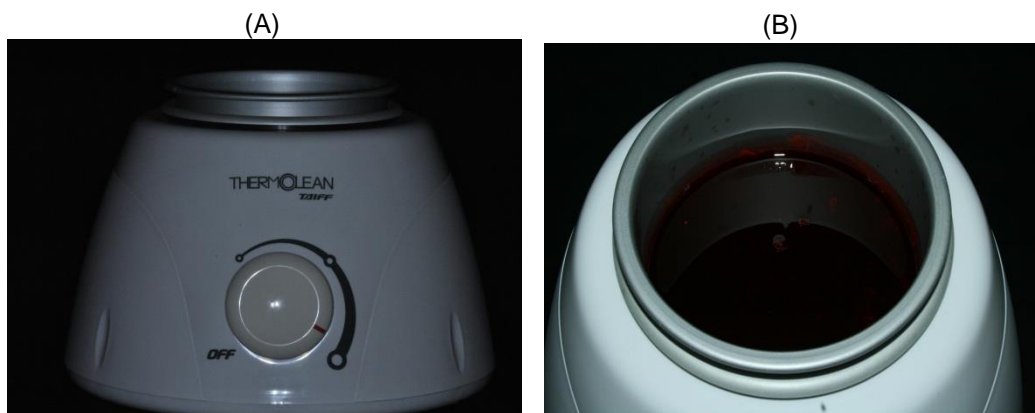
Figura 2 - A) Dispositivo utilizado para aquecimento e derretimento da cera com controle de temperatura; B) cera liquefeita no interior do dispositivo a temperatura de 70° C.
