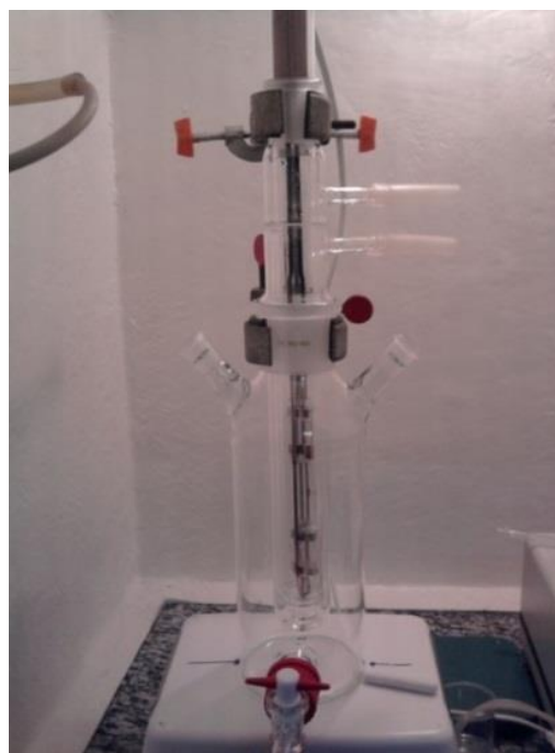
Figura 11 – Esquema de montagem e partes do reator fotocatalítico de redução.
