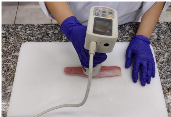
Figura 7 – Análise de cor instrumental por meio do colorímetro Minolta Chrome Meter, pelo método CIELAB.
