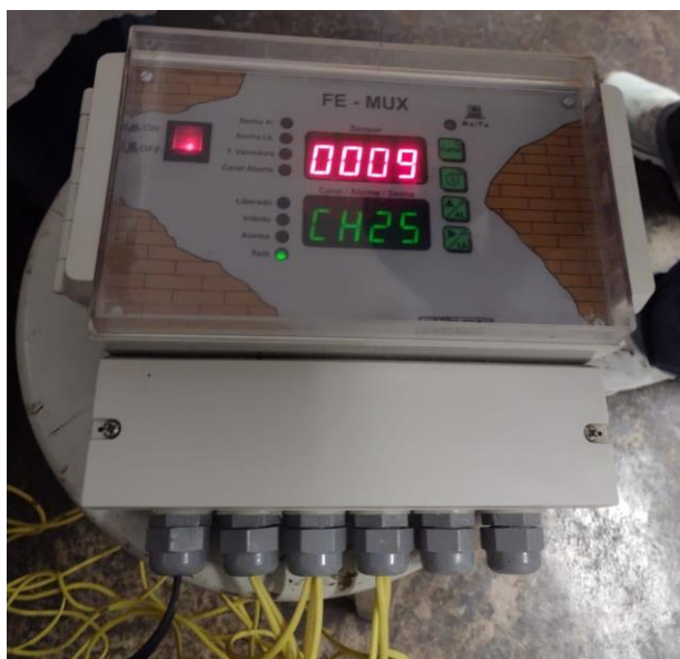
Figura 8 – Termopar, equipamento indicador de temperatura, com registro da temperatura interna das amostras de L. thoracis et lumborum .
