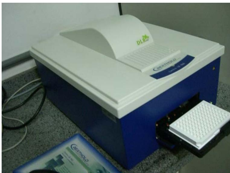
Figura 7: Foto do Luminômetro do Laboratório.
