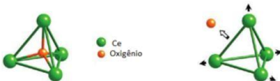
Figura 3.3: Relaxação da estrutura pela remoção de um átomo de oxigênio [23]
