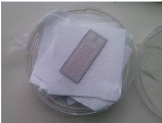
Figura 4.4: Substratos de alumina com caminhos interdigitais de platina preparados no CTI Renato Archer
