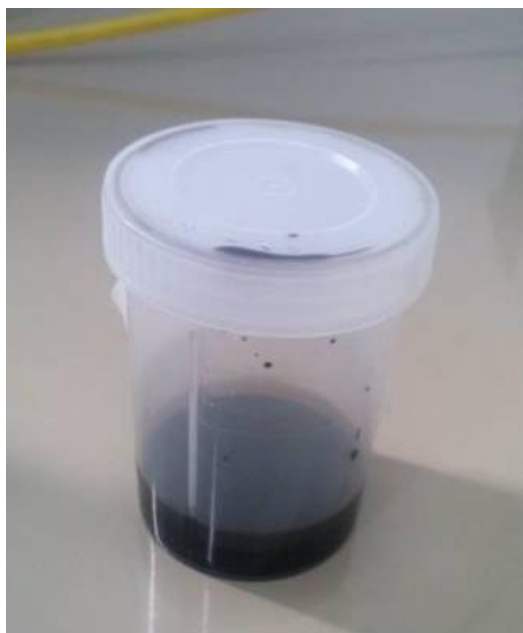
Figura 4. 2: Resina polimérica (citrato de céria) utilizada para obtenção de nanopartículas de \text{CeO}_2
