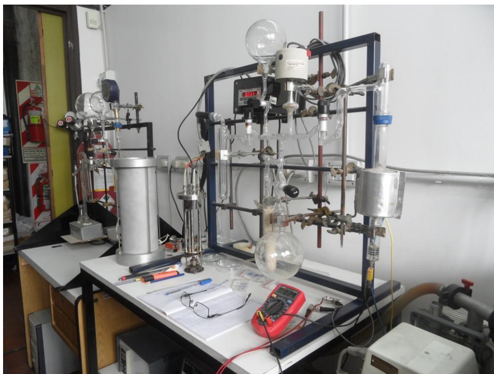
Figura 4.6: Foto da câmara de caracterização sensora [63]
