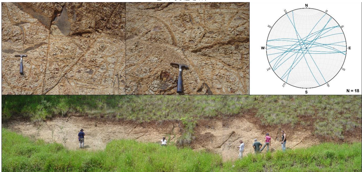
Figura 63: Afloramento do ponto PR_UNESP-17, onde foram coletados dados de falhas normais, dextrais e inversas. O estereograma corresponde aos dados de falhas normais e permitiu reconhecer domínio das famílias E-W e NE-SW.
