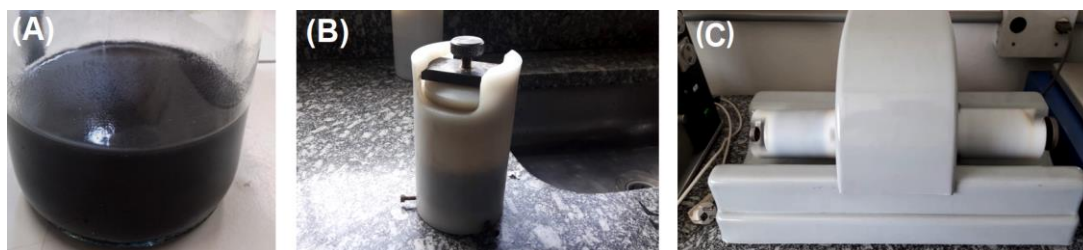
Figura 20 – (A) Suspensão de grafeno em isopropanol após a diluição (B) Jarro com a mistura Alumina, YSZ e MLG; (C) Moinho de bolas durante o procedimento de mistura.
