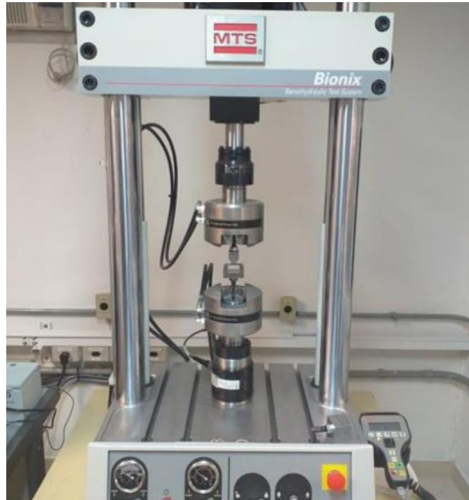
Figura 22 – Máquina universal de ensaios durante o teste de flexão 3 pontos.
