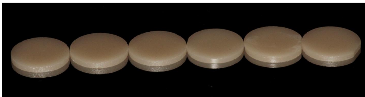
Figura 3 - Amostras cristalizadas em formato de disco padronizados
