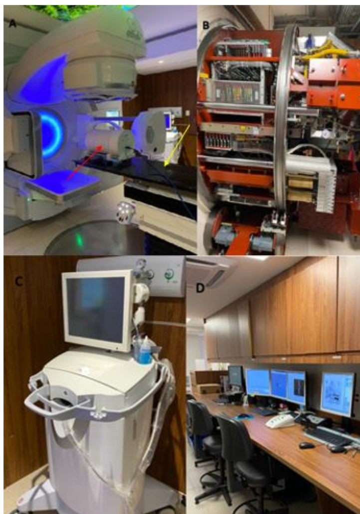
FIGURA 14 – Acelerador Linear - serviço particular da cidade de São Paulo. A) Acelerador Linear com a mesa 6D (seta amarela) e o phantom (seta vermelha) utilizado no controle de qualidade; B) Parte traseira do equipamento (sistemas elétricos); C) US utilizado para guiar o procedimento por imagem em casos específicos, como por exemplo, em tratamento da próstata; D) mesa de comandos, onde ocorre a liberação da dose e acompanhamento do paciente durante o tratamento. Fonte: Material elaborado pela autora, 2022.
