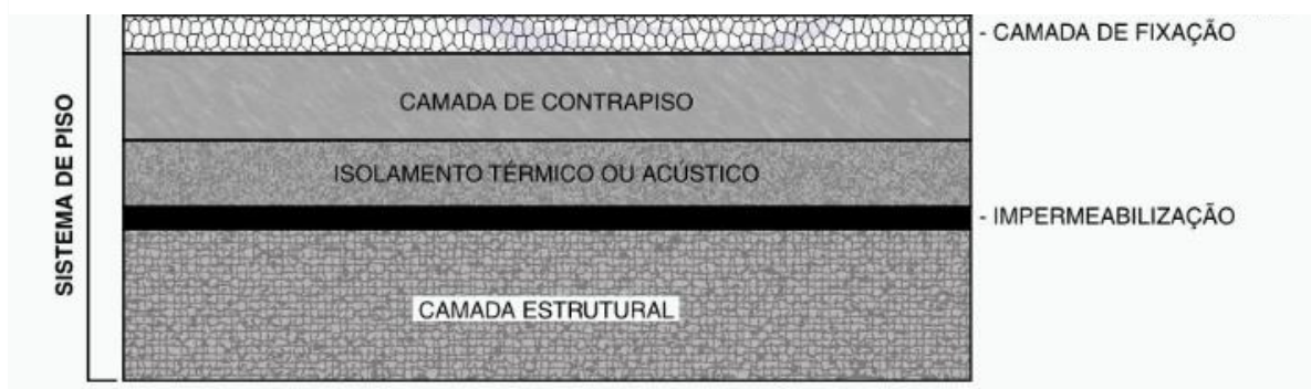
Figura 1 - Exemplo genérico de um sistema de piso e seus componentes
