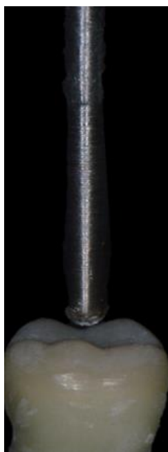
Figura 17 - Corpo de prova no qual foi aplicado o teste monotônico
