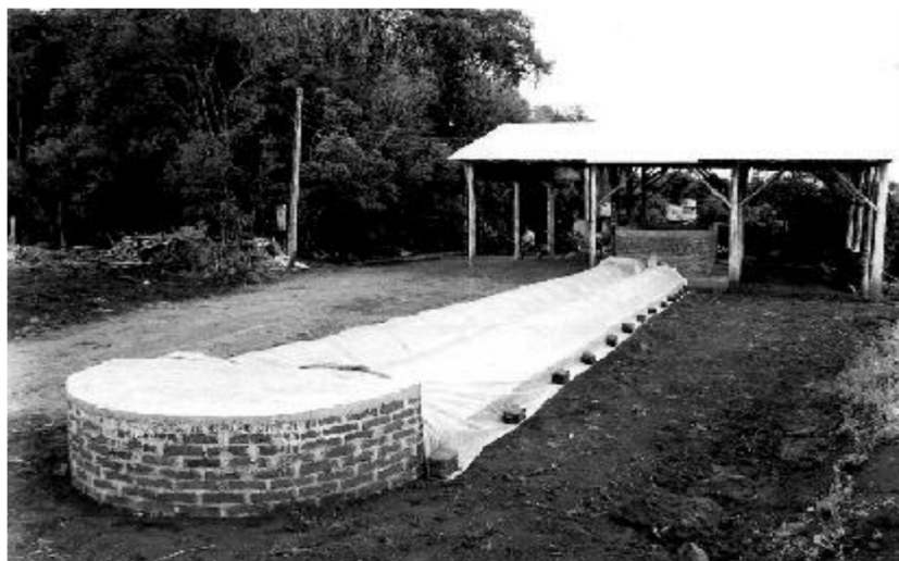
Figura 5- Coletor solar de convecção natural para secagem de grãos projetado pela EMATER- RS.
