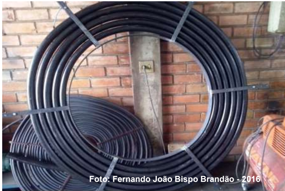
Figura 6- Coletor solar de tubo de polietileno extrudado em espiral usado no experimento
