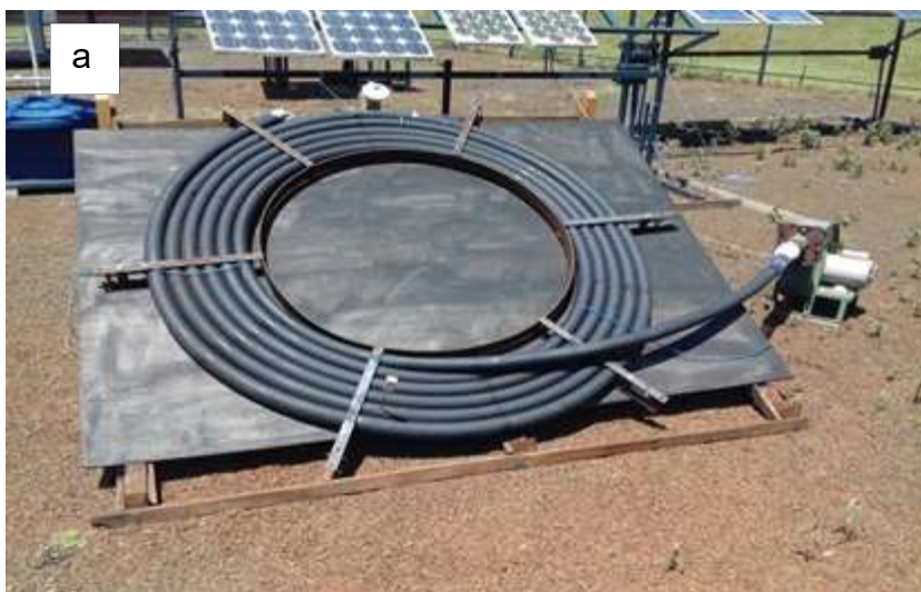
Figura 8- Coletor solar sem cobertura (a); com cobertura de plástico de estufa (b); e com cobertura de vidro (c)
