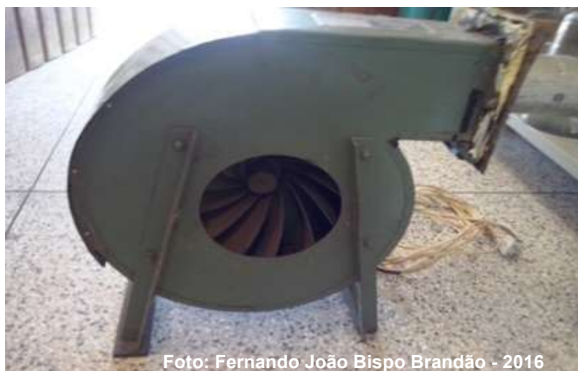
Figura 16- Ventilador centrífugo da marca Blasi, usado no experimento.
