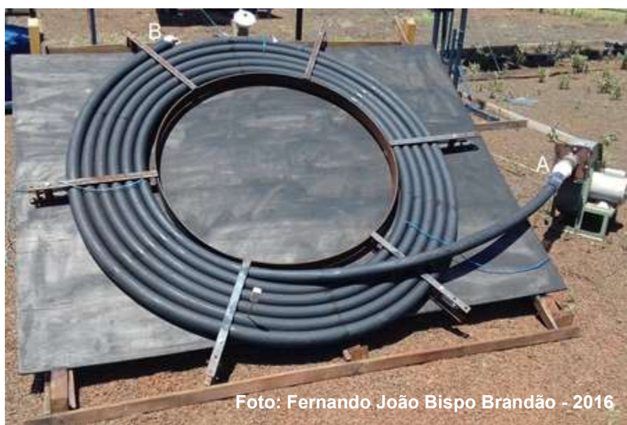
Figura 9- Posição dos termopares no coletor solar de polietileno, sendo os pontos A: Temperatura de entrada, B: Temperatura de saída.
