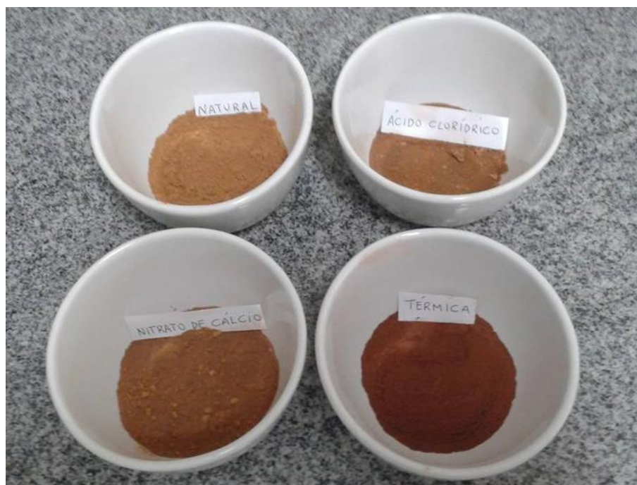
Figura 6 - Amostras de lama vermelha natural e ativada a 400°C, \text{HCl} 0,05 N e \text{Ca}(\text{NO}_3)_2 0,1 N.
