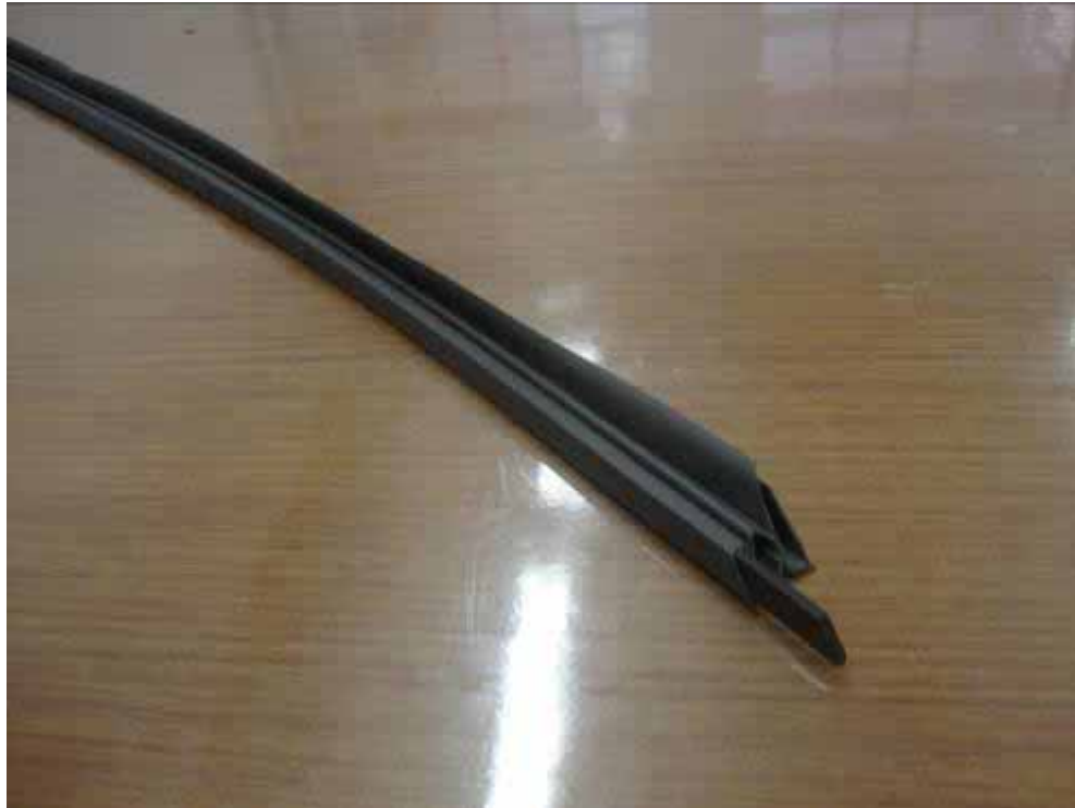
Figura 4 Gaxeta de borracha com miolo magnético
