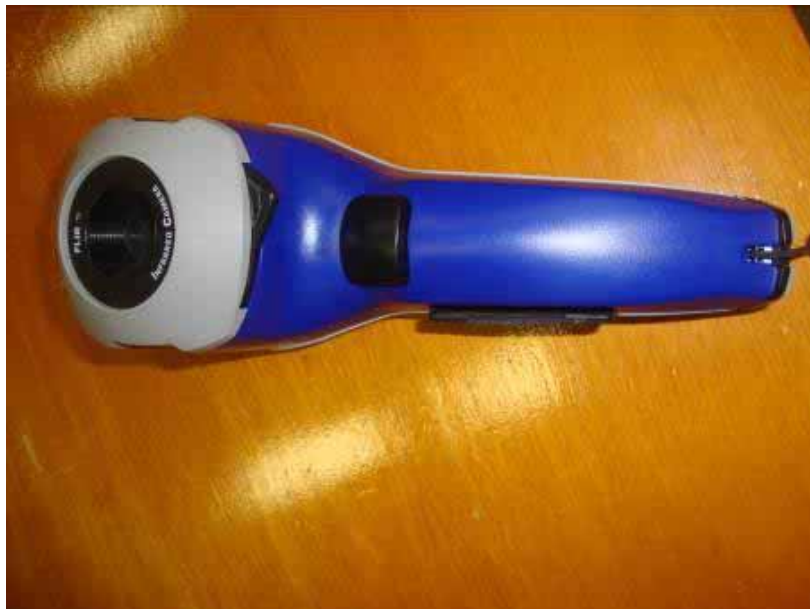
Figura 11: Câmera Infravermelha FLIR i5, Lente e Gatilho
