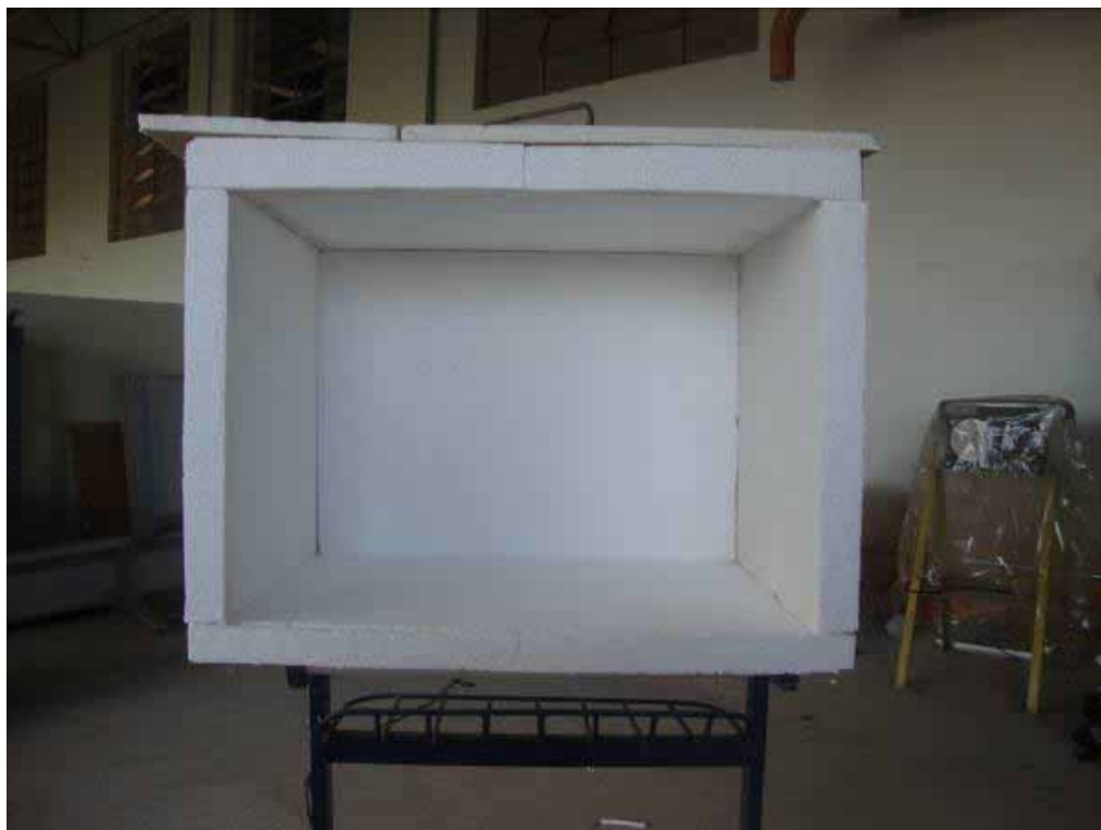
Figura 2: Revestimento em Poliestireno Expandido – Interior e Extremidades
