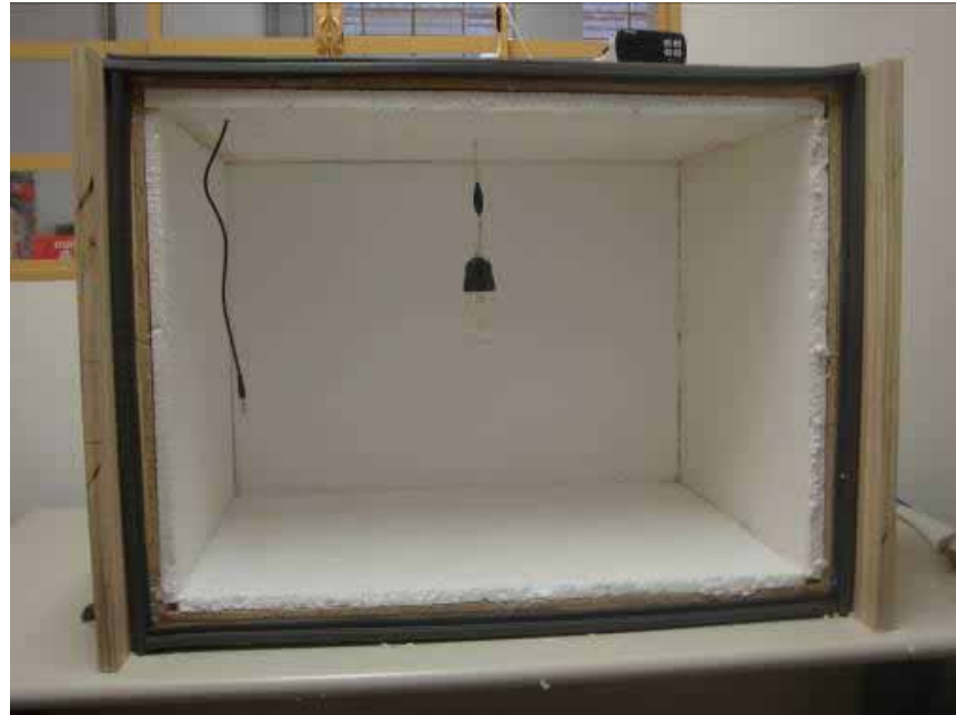
Figura 6: Câmara Térmica, Fonte de Calor, Termopar e Termostato
