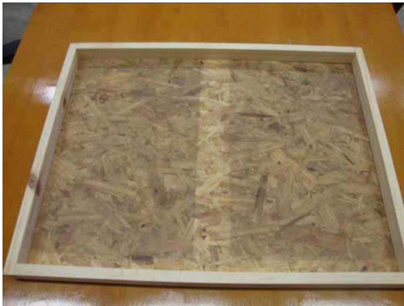
Figura 20: Parede OSB Parcialmente Montada
