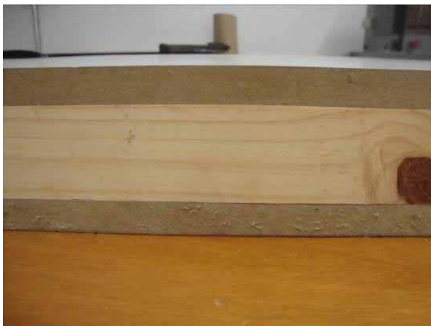
Figura 18: Camadas de MDF sobre frame
