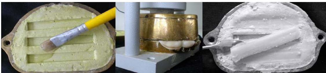
Figura 3 – Molde obtido para prensagem da resina acrílica; prensagem do material e espécime após desinclusão.
