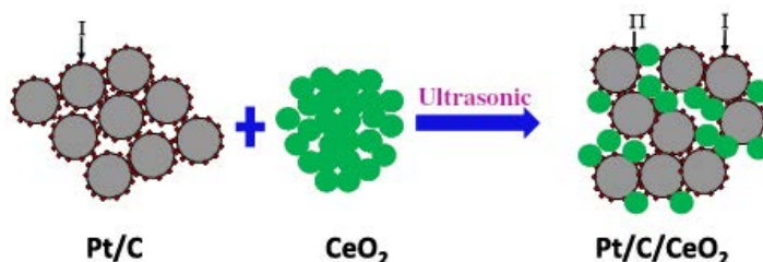
Figura 4: Representação esquemática proposta por Yu e Xi 43 para preparação de Pt/C + \text{CeO}_2 para gerar estruturas com junção tripla.
