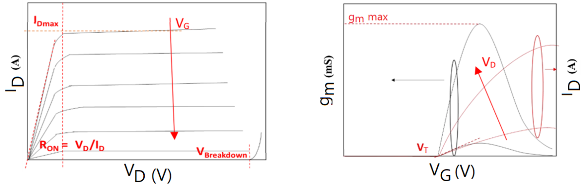
Figura 6 – Características de saída (a) e de transferência (b) dos AlGaIn/GaN HEMTs.
