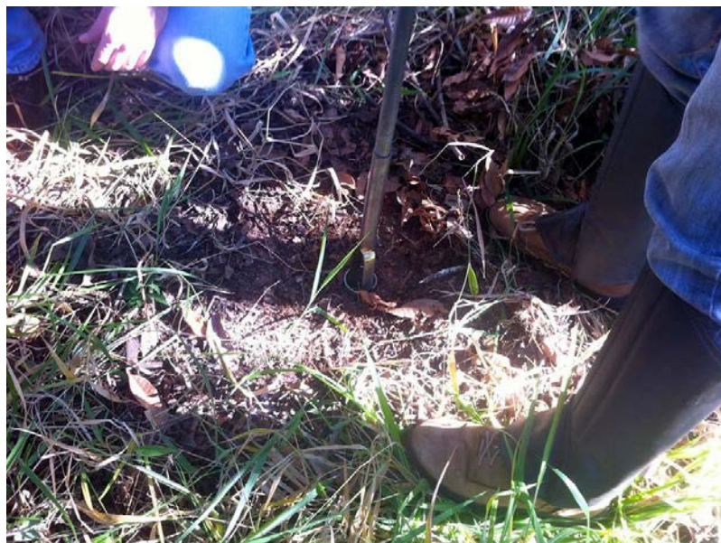
Figura 49: Abertura de orifício para a instalação do Permeômetro de Guelph.
