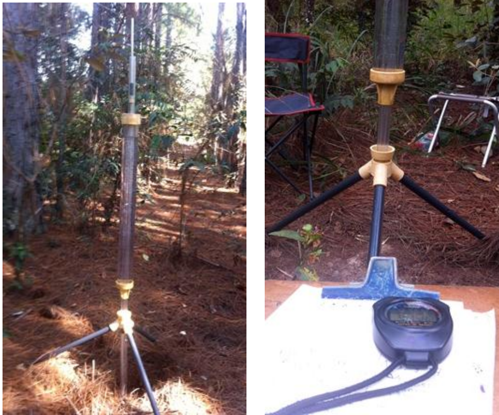
Figura 50: Permeâmetro de Guelph e medição da permeabilidade do solo.
