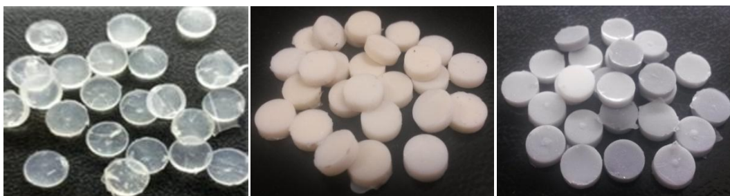
Figura 6 – Corpos de prova de silicone incolor e pigmentado (médio e preto).
