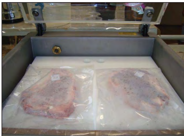
Figura 4. Amostras de 2,5 cm de espessura do músculo Longissimus sendo embalada à vácuo.
