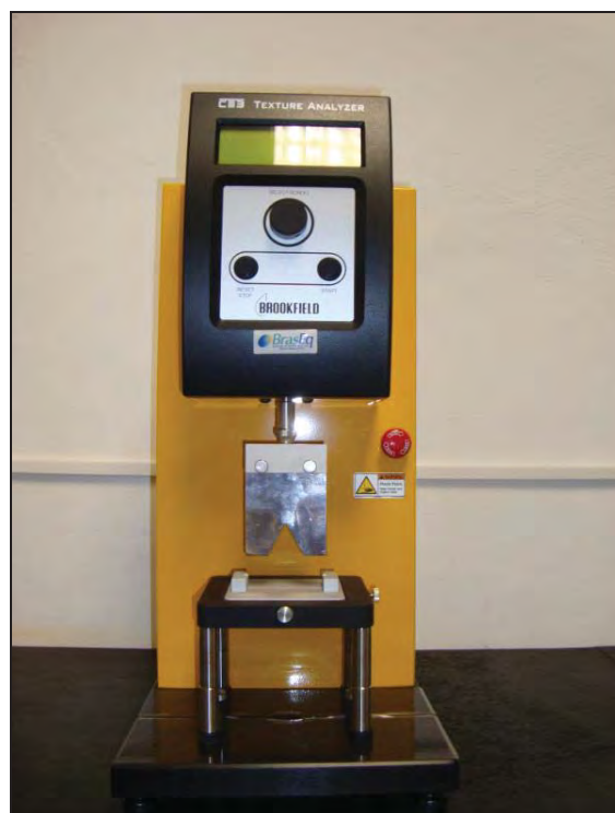
Figura 7. Texturômetro acoplado à lâmina Warner-Bratzler.
