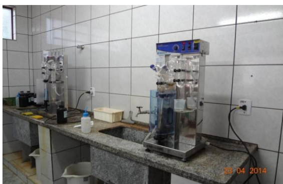
Figura 29. Destilador (esquerda) e titulador (direita) para determinação de N. Ilha Solteira (SP).
