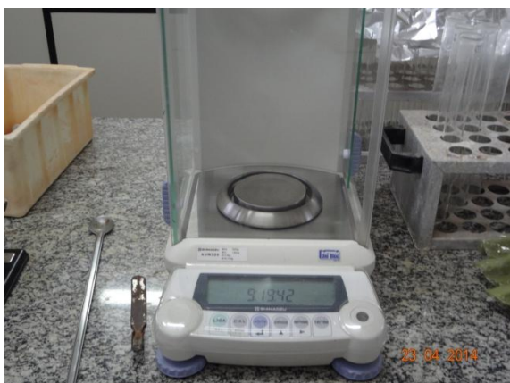
Figura 28. Amostras moídas são pesadas para digestão sulfúrica (determinação de N). Ilha Solteira (SP).
