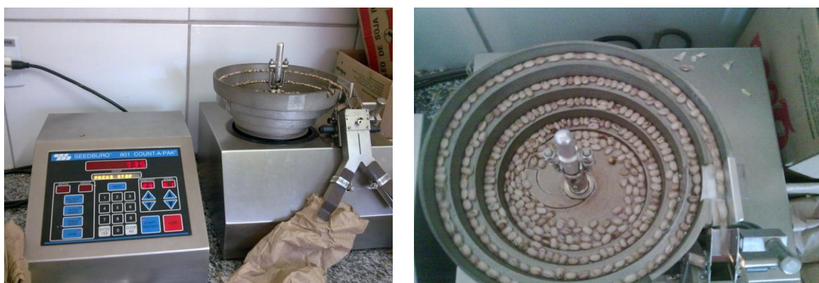
Figura 47. Contador Mecânico de grãos para determinação de grãos por vagem.
