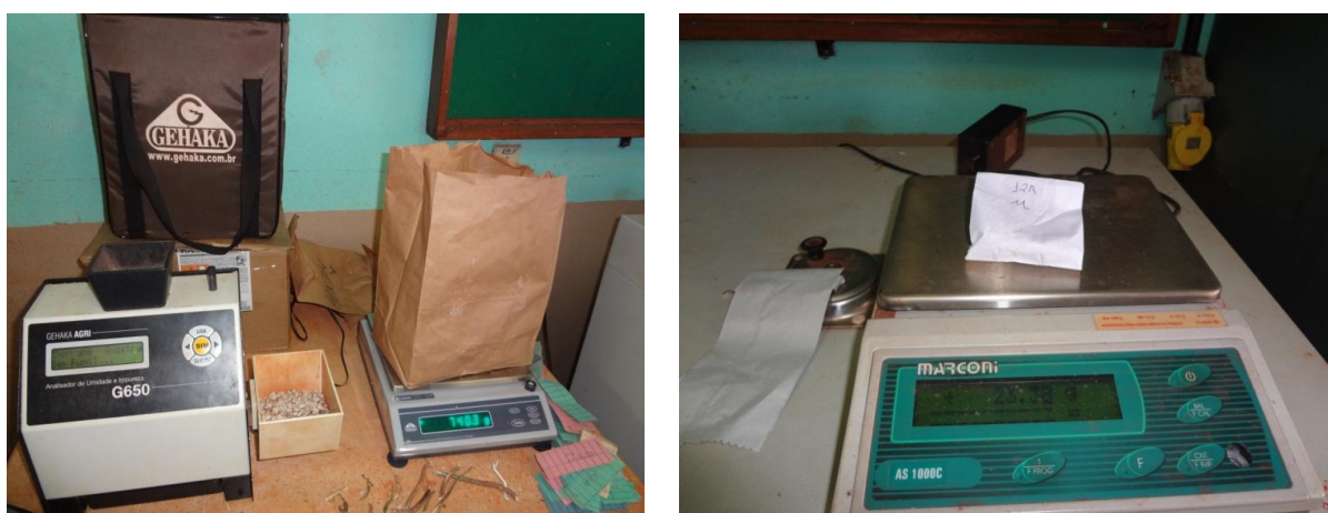
Figura 46. Determinação de produção, massa de 100 grãos e umidade. Selvíria/MS.
